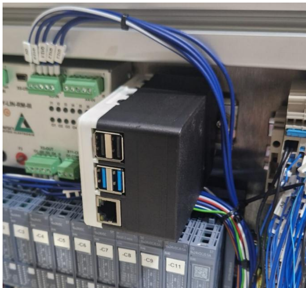
Figura 8 - Exemplo de aplicação de um Raspberry Pi a nível industrial.
