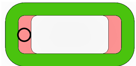
Figura 67 - Interseção entre as peças A e B; Localização do poka-yoke
