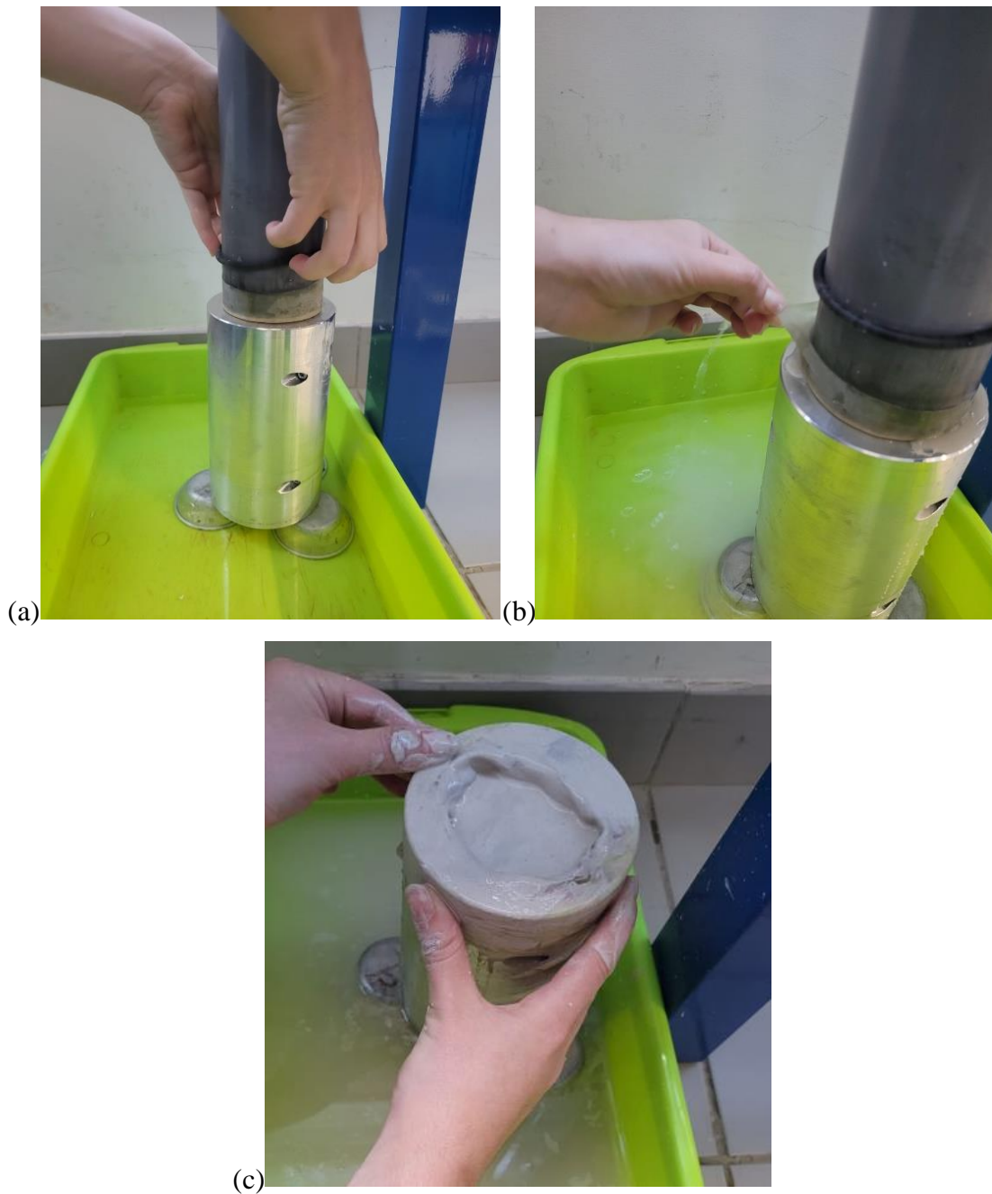
Figura 49 – Retirada do tubo de PVC
