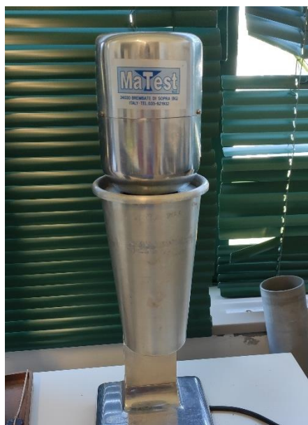
Figura 24 - Provete sendo misturado com o auxílio de misturador mecânico
