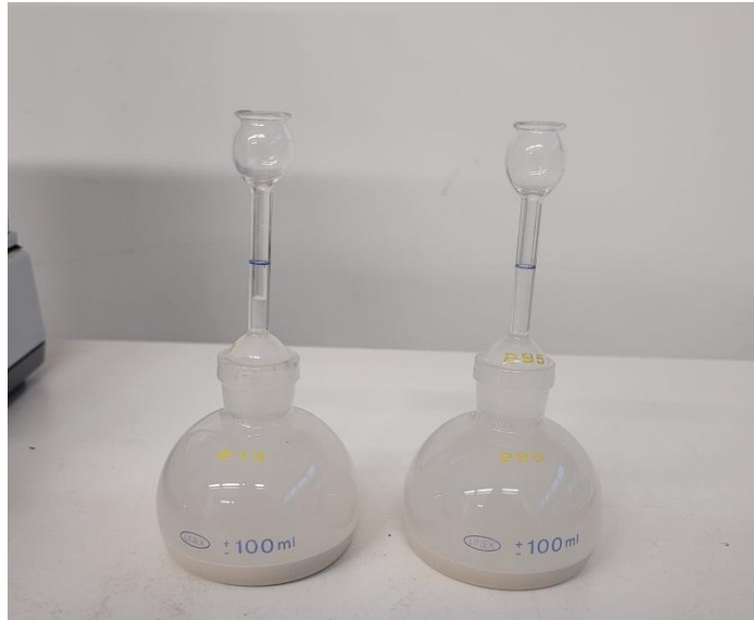
Figura 33 - Execução do ensaio de determinação da densidade de partículas sólidas
