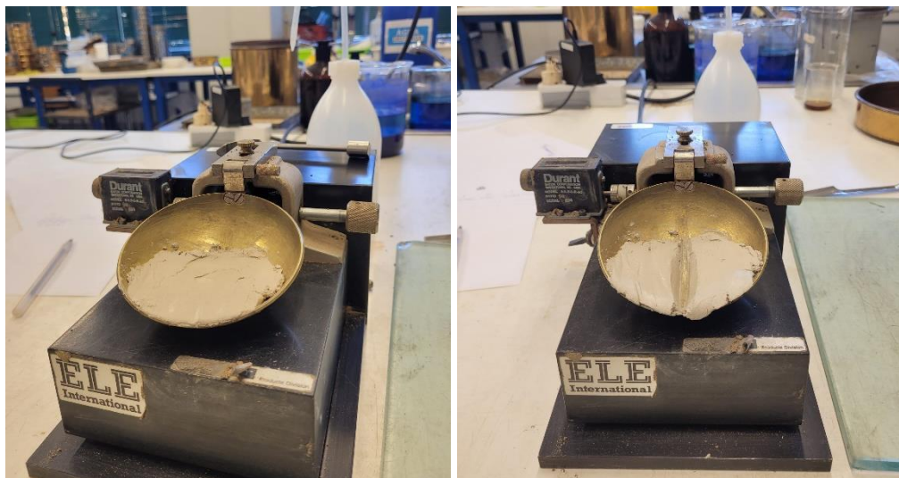
Figura 28 - Ensaio de limite de liquidez na Concha de Casagrande do material PP2
