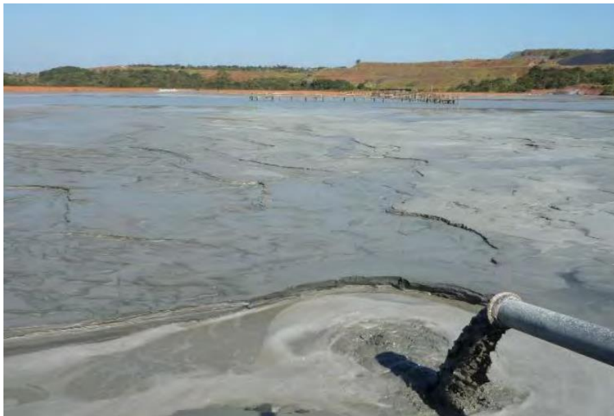
Figura 3 - Deposição de rejeitado sob a forma de polpa em barragem convencional (França & Trampus, 2018).
