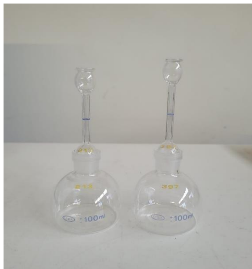
Figura 31 - Picnómetros utilizados para determinação da densidade de partículas sólidas
