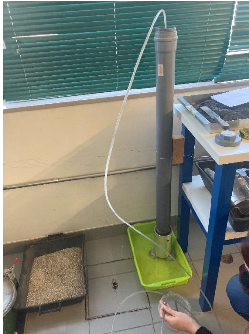
Figura 48 - Retirada do excesso de água com mangueira
