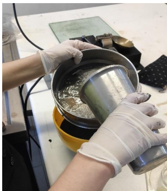
Figura 25 - Provete sendo lavado no peneiro de 63 \mu\text{m}
