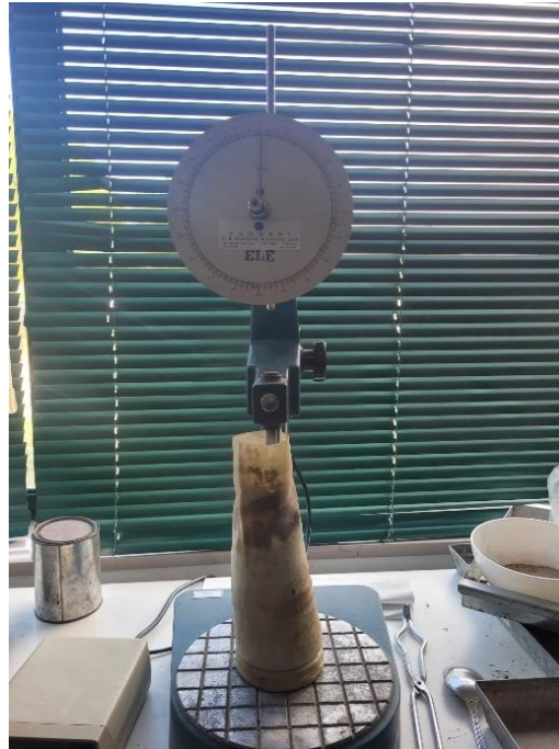
Figura 52 - Ensaio de penetração com agulha no PROV2
