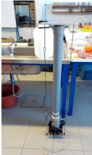
Figura 18 - Equipamento para reconstituição de provetes (Jorge, 2020).
