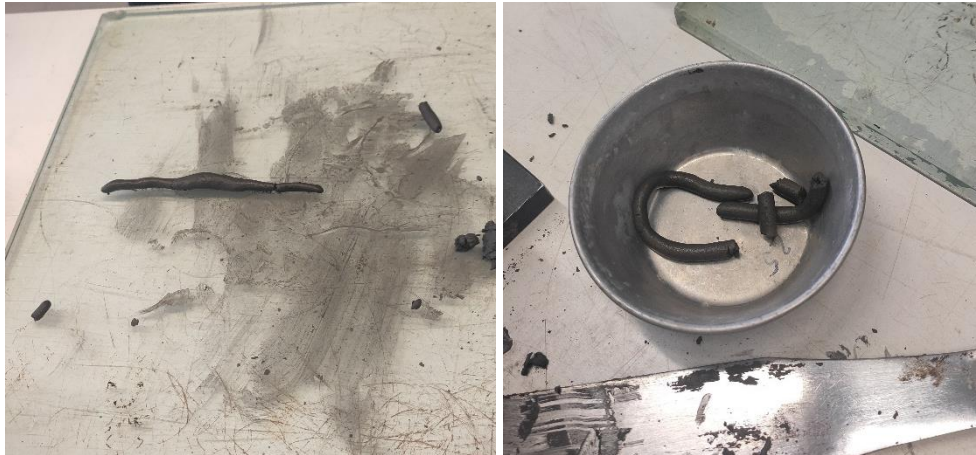
Figura 29 - Ensaio de limite de plasticidade do rejeitado RJ1
