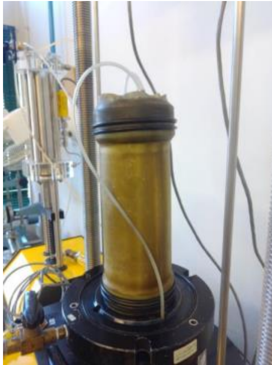
Figura 19 - Aspeto final do provete reconstituído (Jorge, 2020).
