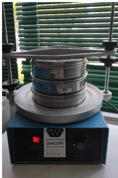
Figura 23 - Peneiração com o auxílio de agitador mecânico
