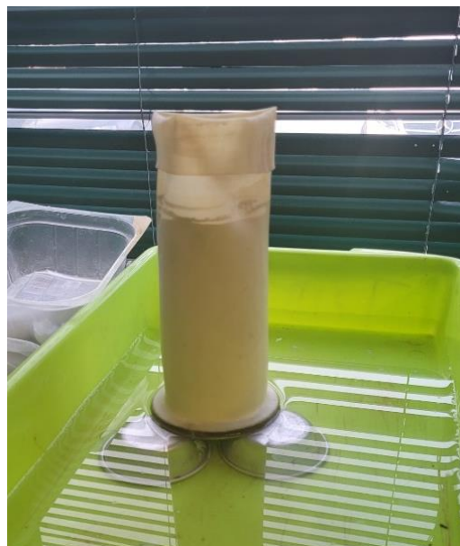
Figura 41 - Provete PROV1 após o desmolde, sobre uma camada de água
