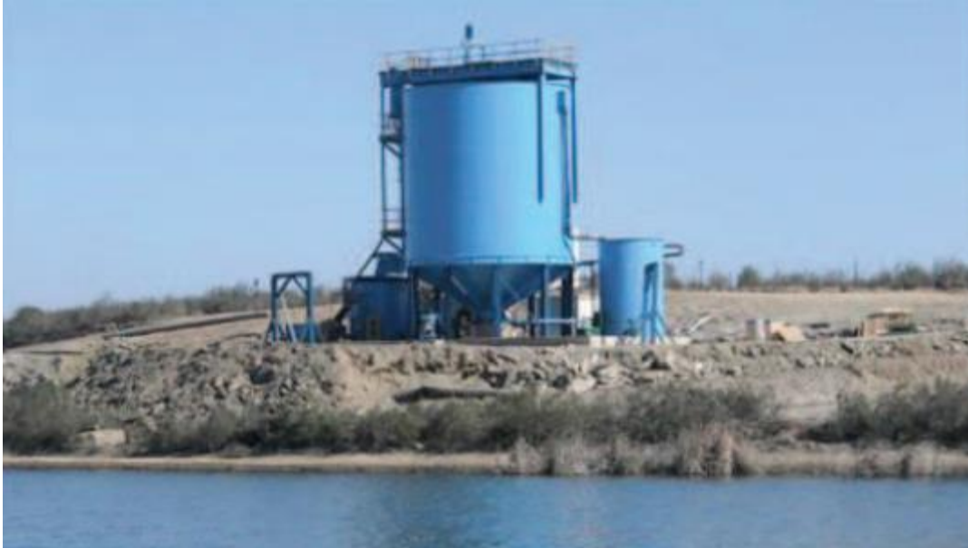
Figura 4 - Espessador de cone profundo (Oliveira, 2011)
