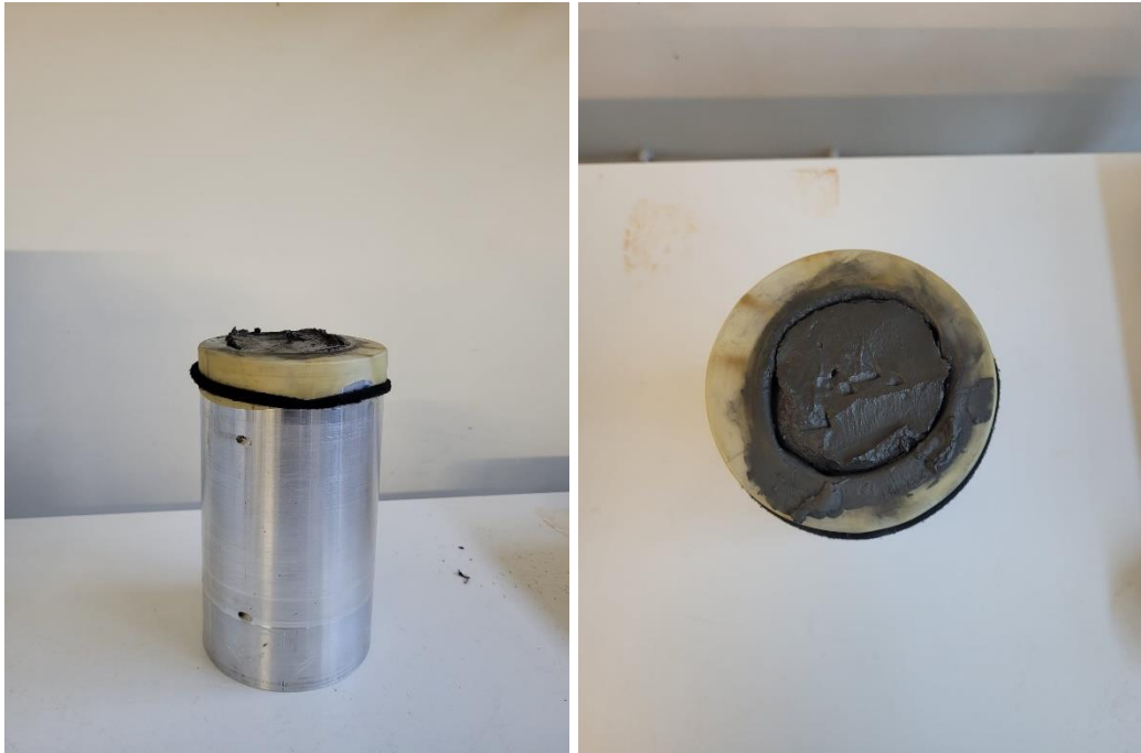
Figura 63 - Provede PROV5 dentro do molde bipartido
