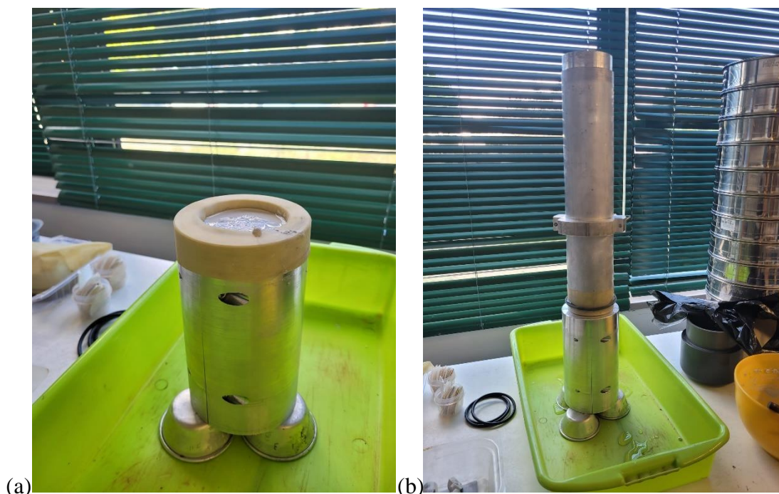
Figura 40 - Montagem do conjunto para sedimentação do PROV1: a) molde com membrana e material; b) com tubo metálico encaixado
