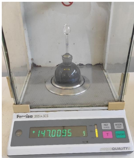
Figura 34 – Aferição da massa do conjunto picnómetro + provete + água destilada
