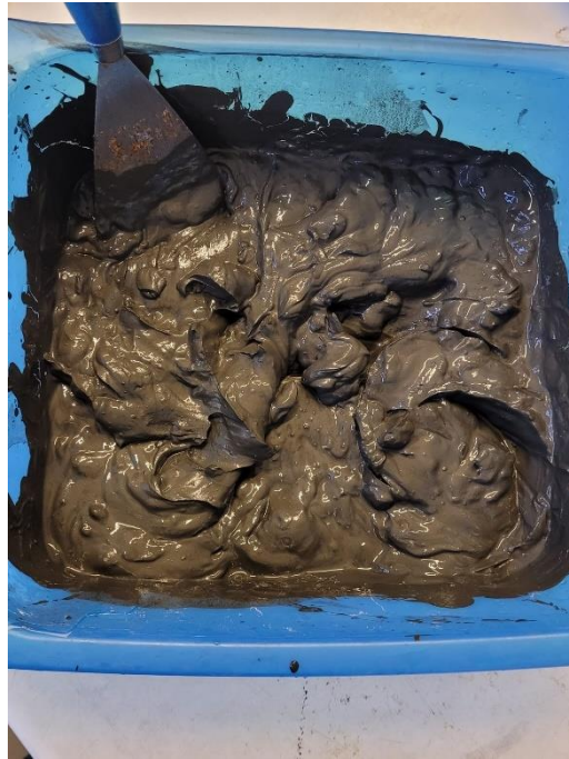
Figura 61 – Mistura utilizada para a reconstituição do provete PROV5
