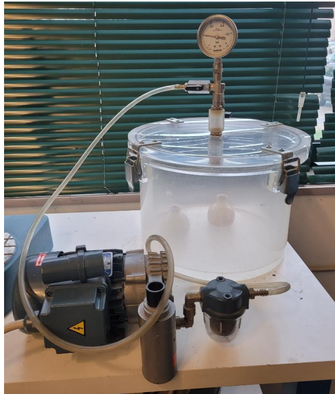
Figura 32 – Remoção de bolhas com o auxílio da bomba de vácuo
