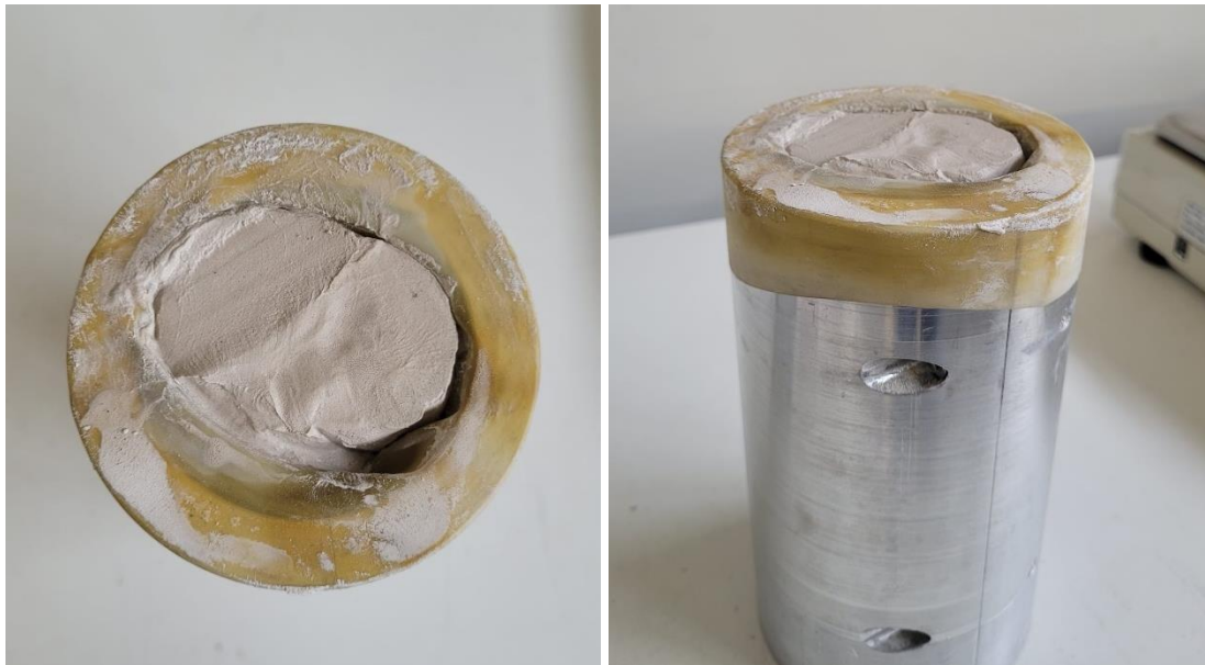
Figura 59 – Provete PROV4 dentro do molde bipartido
