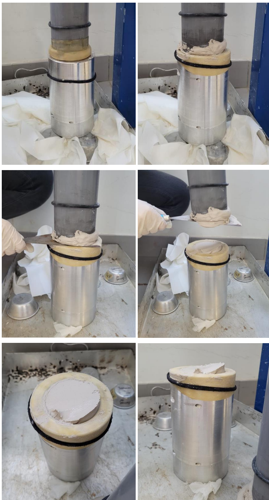
Figura 55 – Remoção do tubo de PVC do PROV3
