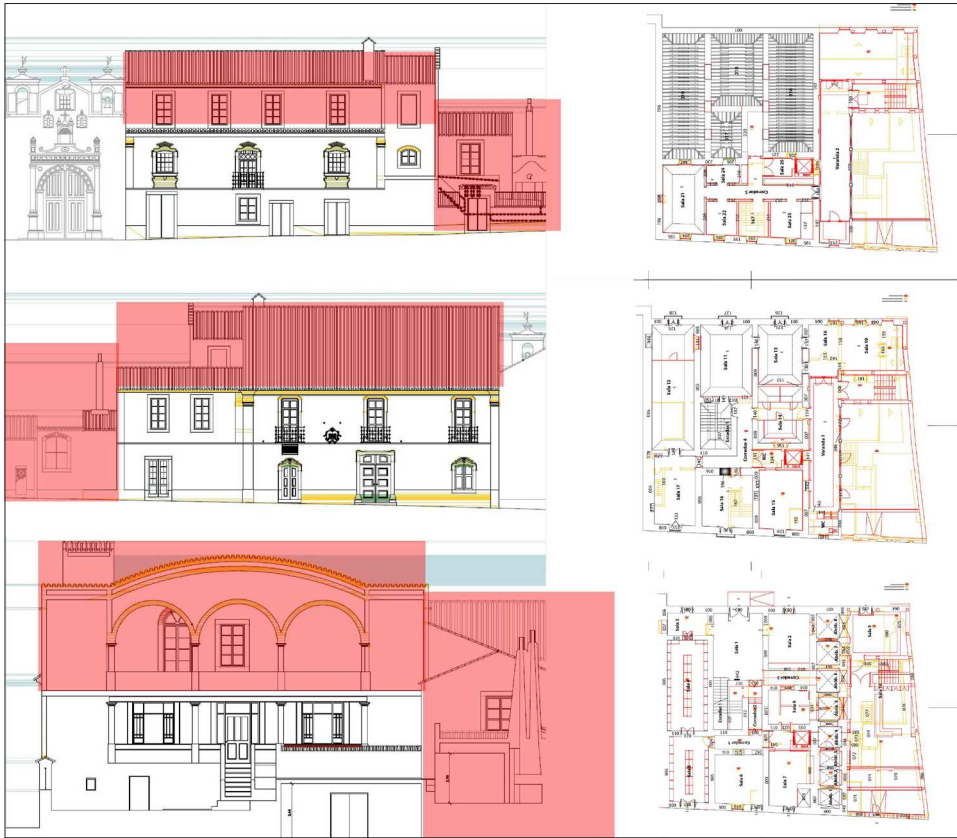
Fig. 4 – Projeto de arquitetura e alçados do com intervenções do século XX destacadas a vermelho (Projeto da autoria do Atelier MAN Arquitetura).
