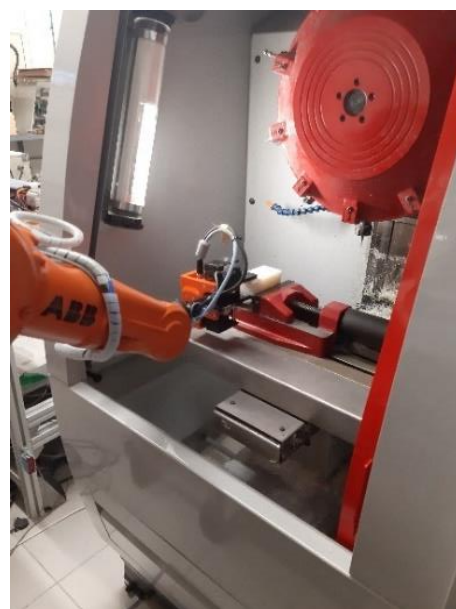
a) Robô a carregar o Torno CNC. b) Robô a carregar a Fresadora CNC.
