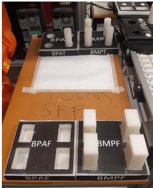
Figura 3-6: Buffer das MP e dos PA do setor de fabrico.
