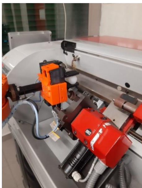
a) Robô a carregar o Torno CNC. b) Robô a carregar a Fresadora CNC.
