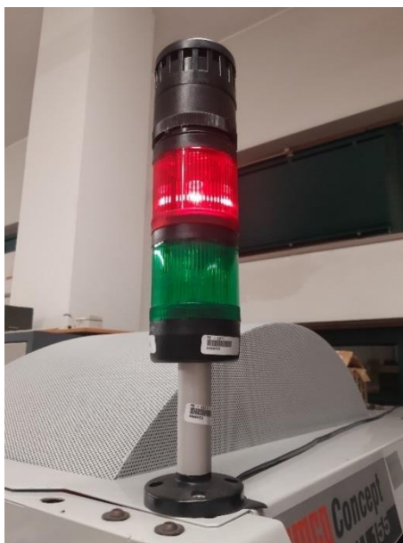
Figura 3-21: Baliza de sinalização implementada no SF.
