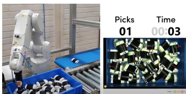
Figura 2-23: Processo BinPicking usando uma câmara de visão artificial 3D [62].
