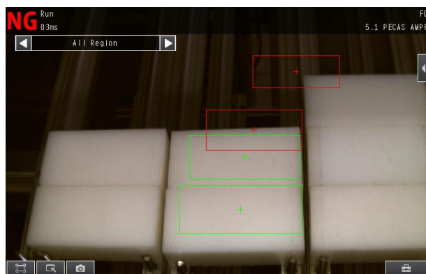
a) Inspeção das primeiras 4 peças da coluna. b) Robô no ponto “pVisão1PAMPF”.
