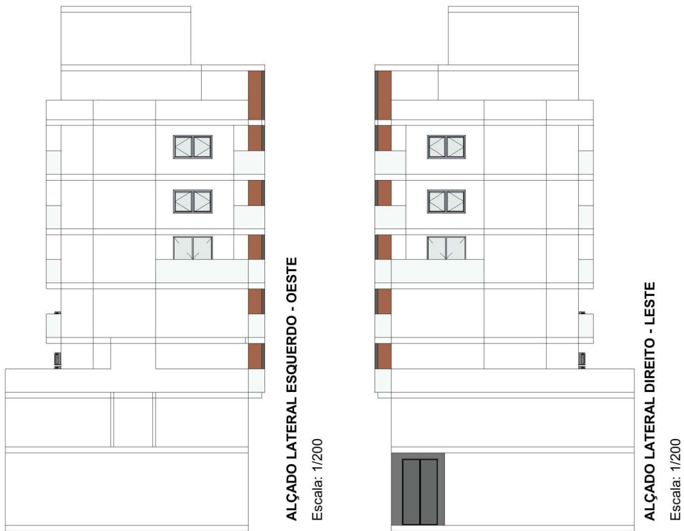
Figura A.11 – Desenho em Revit dos alçados laterais
