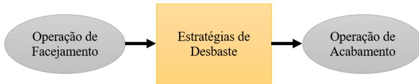
Figura 51: Ordem das operações de torneamento
