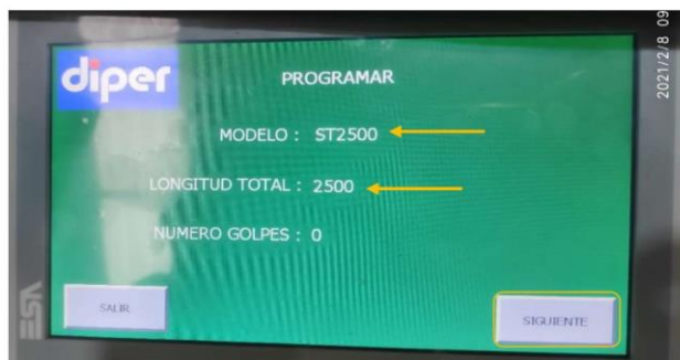
FIGURA 5 – NOME DO PROGRAMA E COMPRIMENTO DO POSTE
