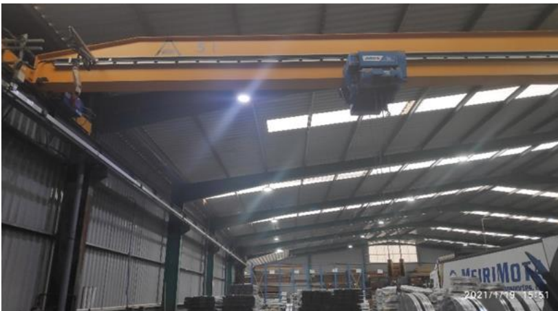
Figura 9 - Grua e transporte dos rolos
