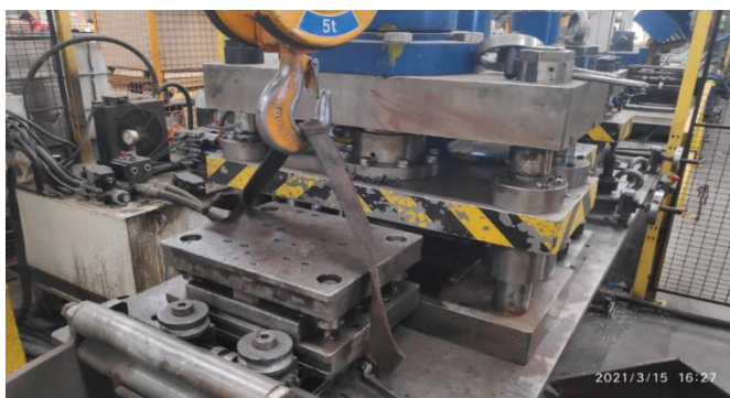
Figura 12 - Troca da ferramenta da prensa 3 e mudança da furação da ferramenta da máquina 2
