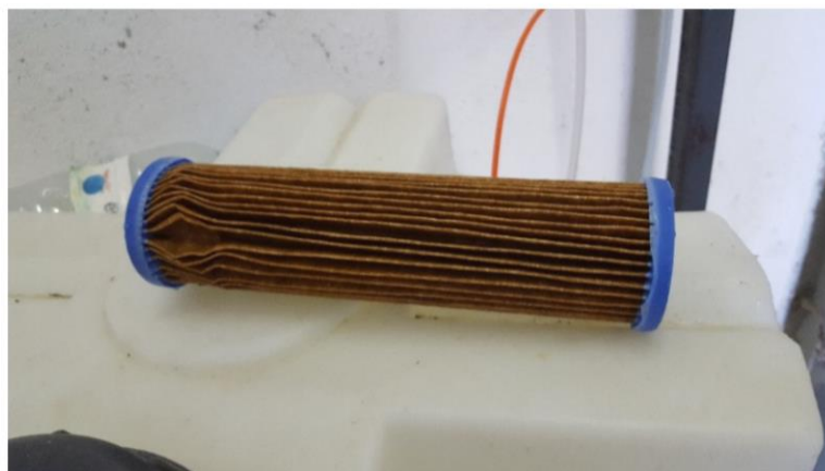
Figura 31-8: Filtro colmatado de impurezas presente num reservatório.
