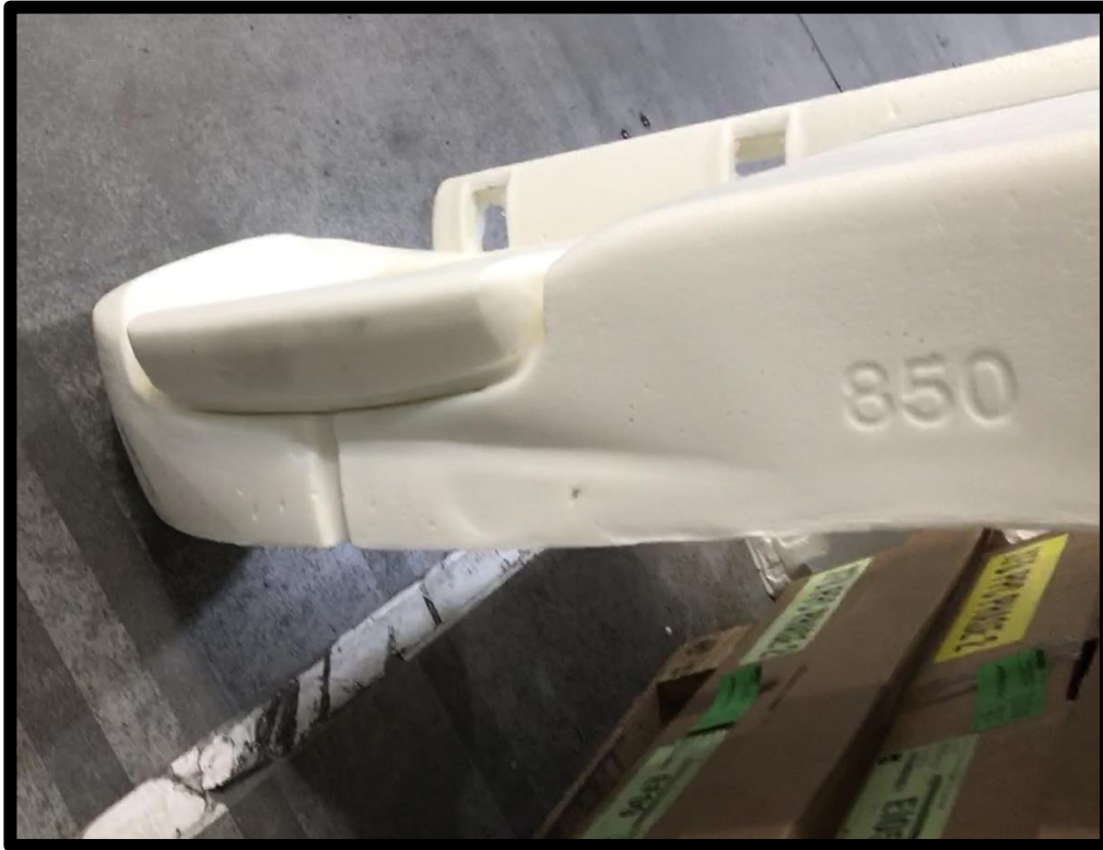
Figura 67 - espuma marcada pela régua do camião
