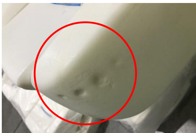
Figura 26 - Espuma com deformação causada pelos dedos do operador quando se encontra em formação
