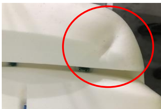
Figura 25 - Espuma com deformação na lateral causada pelos carros de transporte
