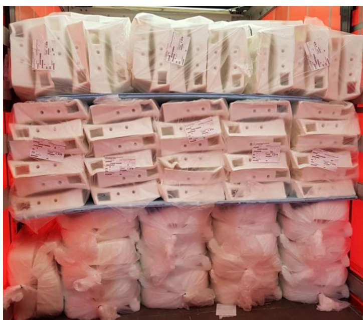
Figura 41 - Placas de Roofmate a separar cada nível de espumas
