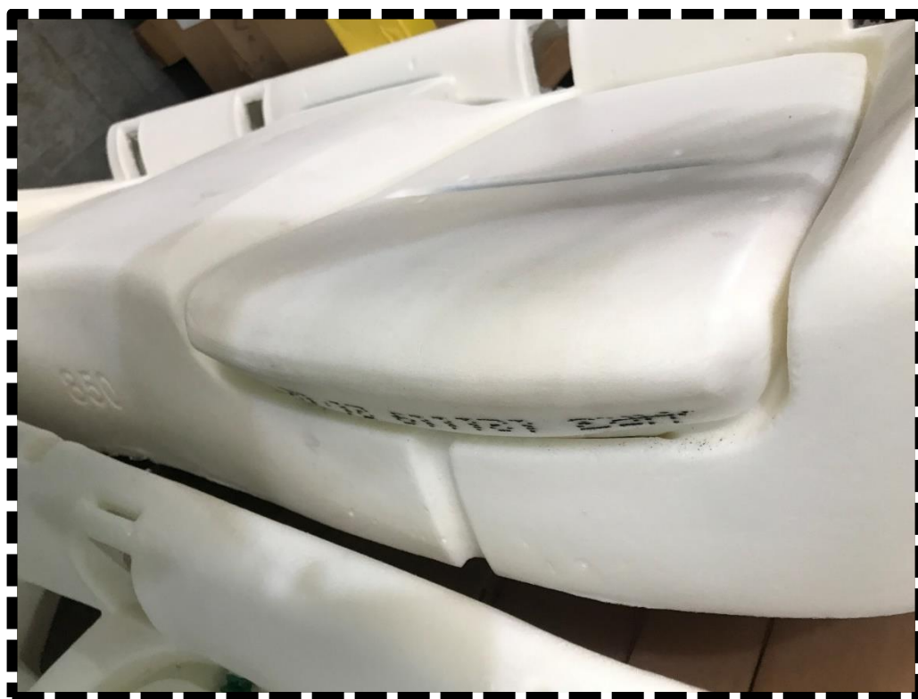
Figura 66 - Espuma deformada pelo peso das espumas que vêm por cima
