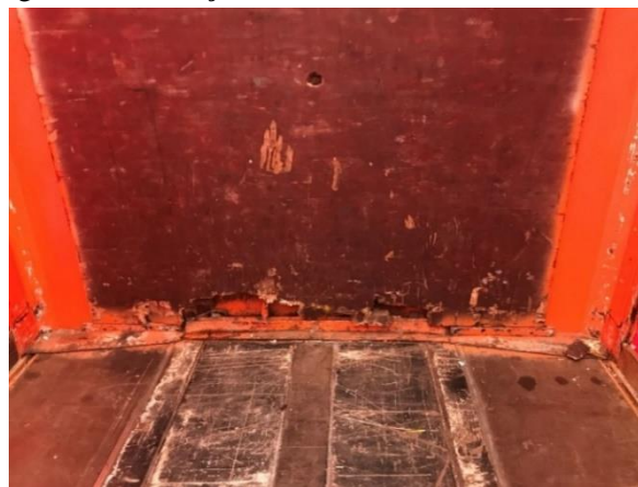
Figura 30 - Fundo do camião danificado
