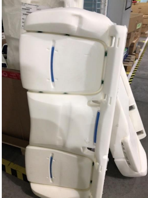
Figura 50 - Deformações provocadas pela deslocação dos sacos
