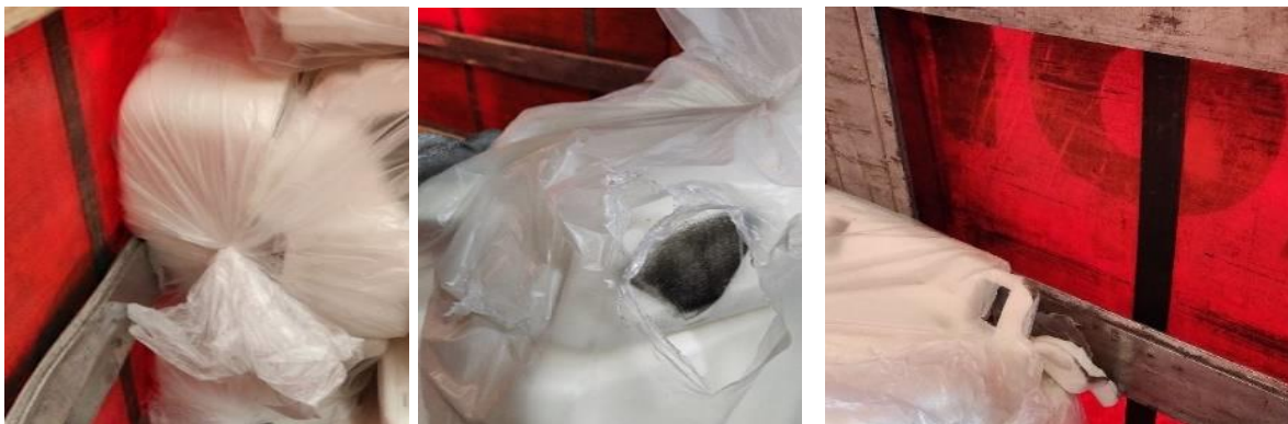
Figura 36 - Exemplos de espumas deformadas/rasgadas nas réguas
