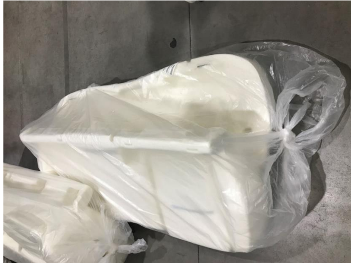
Figura 34 - Bolsa apertada com nó, as espumas movimentam-se livremente
