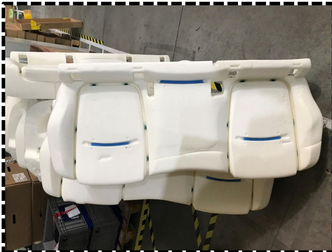
Figura 65 - Espuma com marca dos isofix de outra espuma
