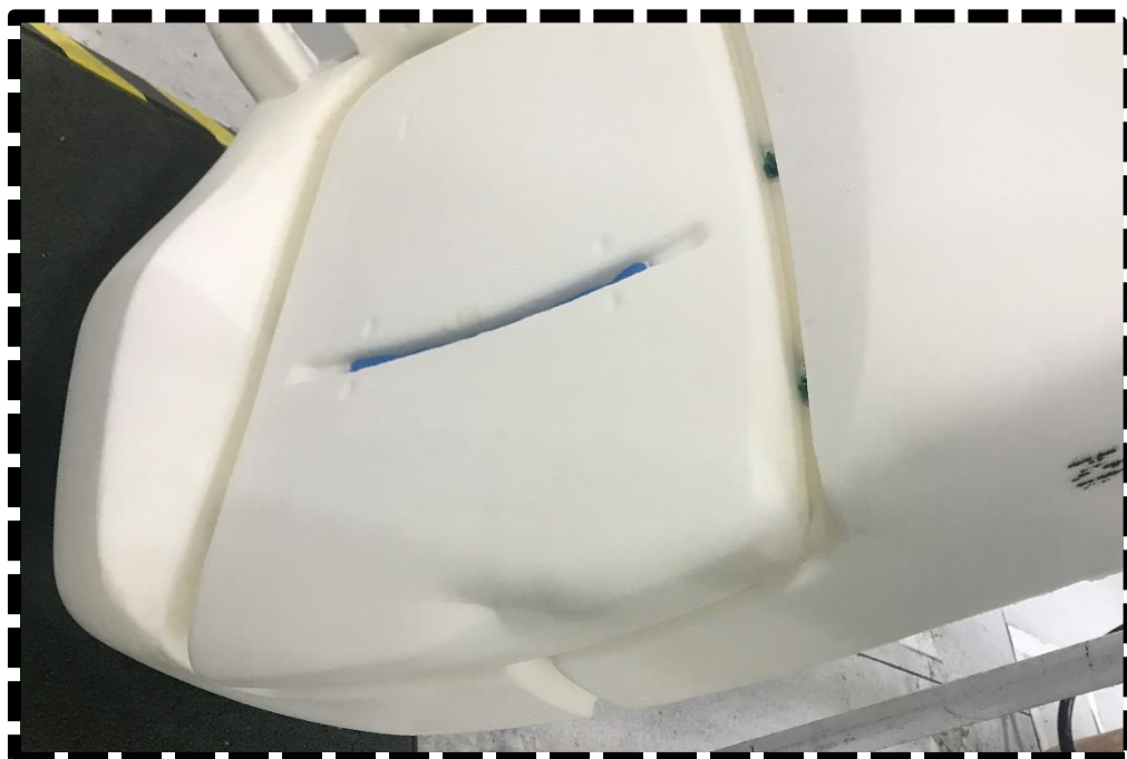
Figura 57 - Deformação na zona do assento parte frontal provocada pela régua do camião
