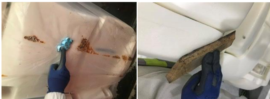
Figura 37 - Exemplos de lixo que provocaram deformação em espumas
