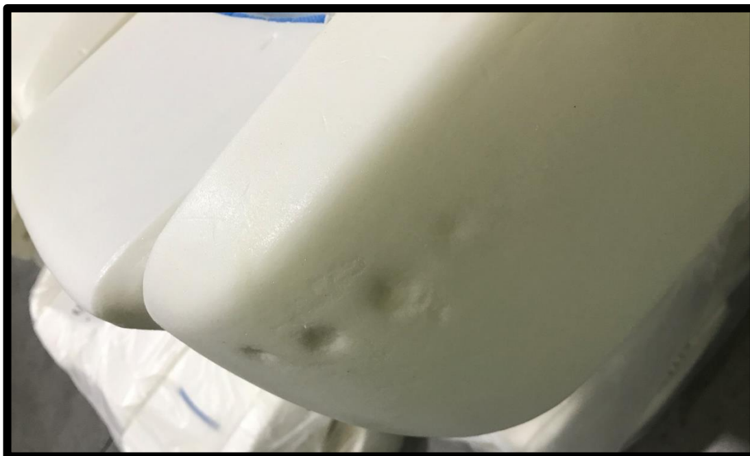
Figura 61 - Deformação causada pelo operador do fornecedor que está em formação quando retira a espuma do molde
