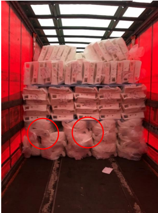
Figura 48 - Sacos invertidos de CAR e mal posicionados
