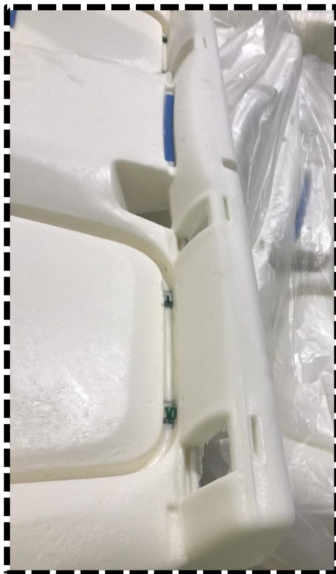
Figura 58 - Deformação na zona dos ISOFIX provocada pelo roofmate
