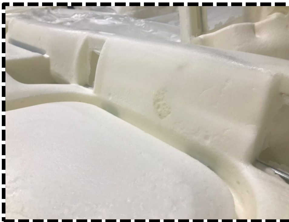
Figura 59 - Deformação provocada por mau carregamento
