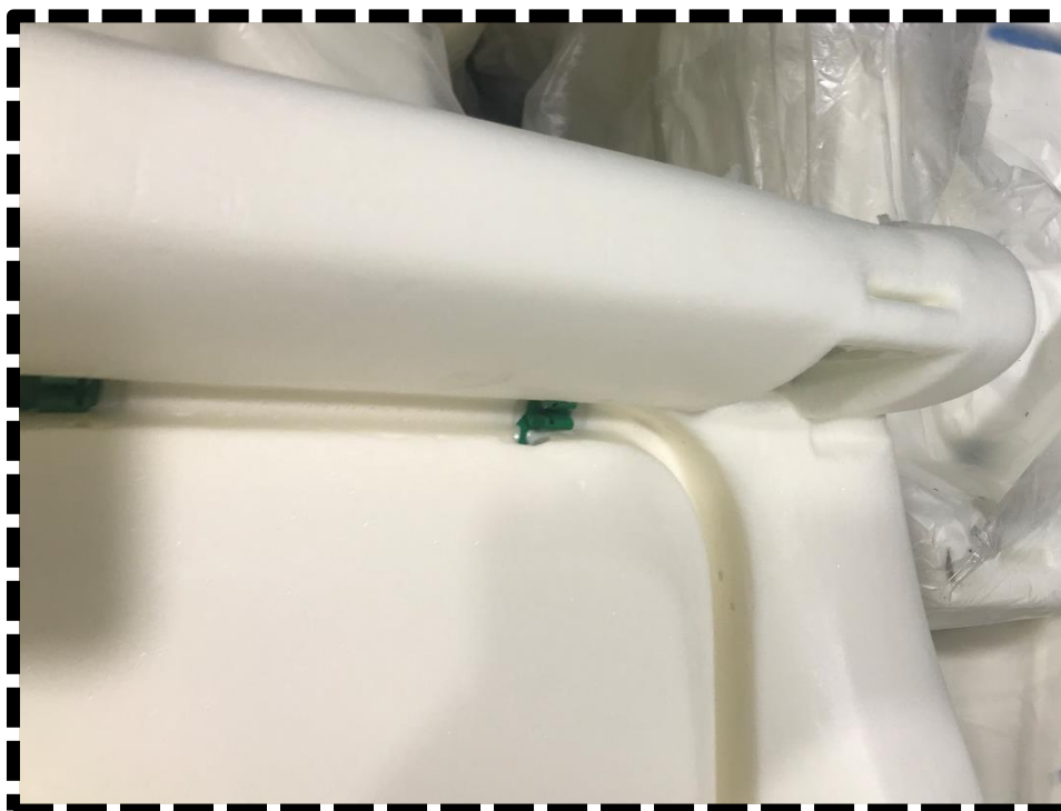
Figura 60 - Deformação na parte de trás dos ISOFIX porque a espuma ficou trilhada nas réguas do camião
