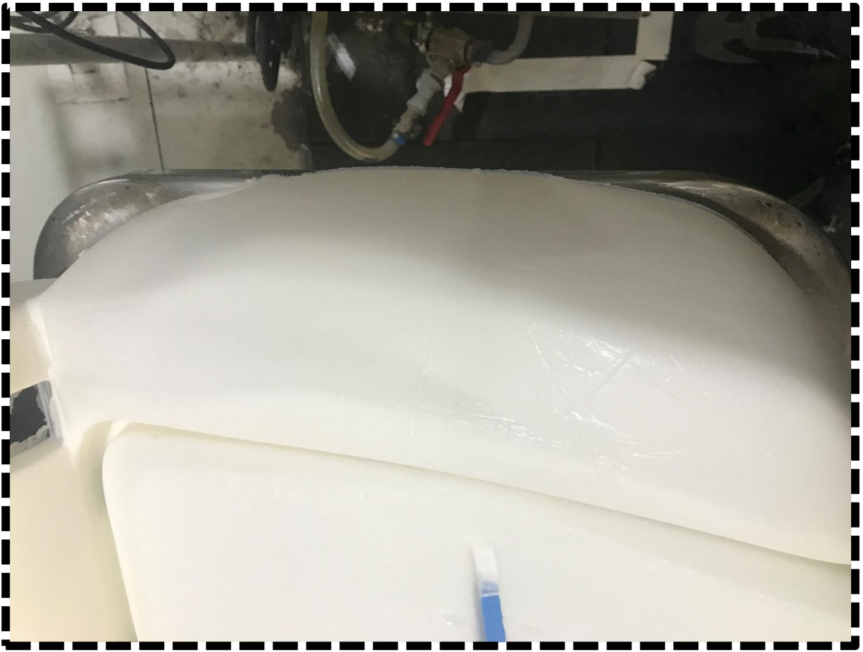
Figura 56 - Deformação na zona lateral da espuma provocada pelo mau posicionamento do roofmate
