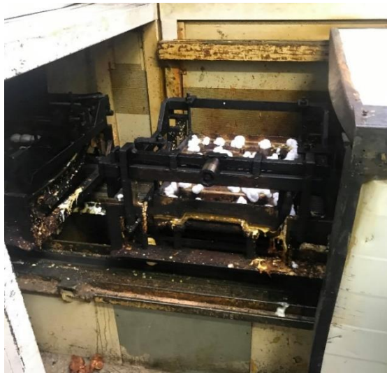
Figura 12 - Saída dos excessos de espuma pelos orifícios do molde
