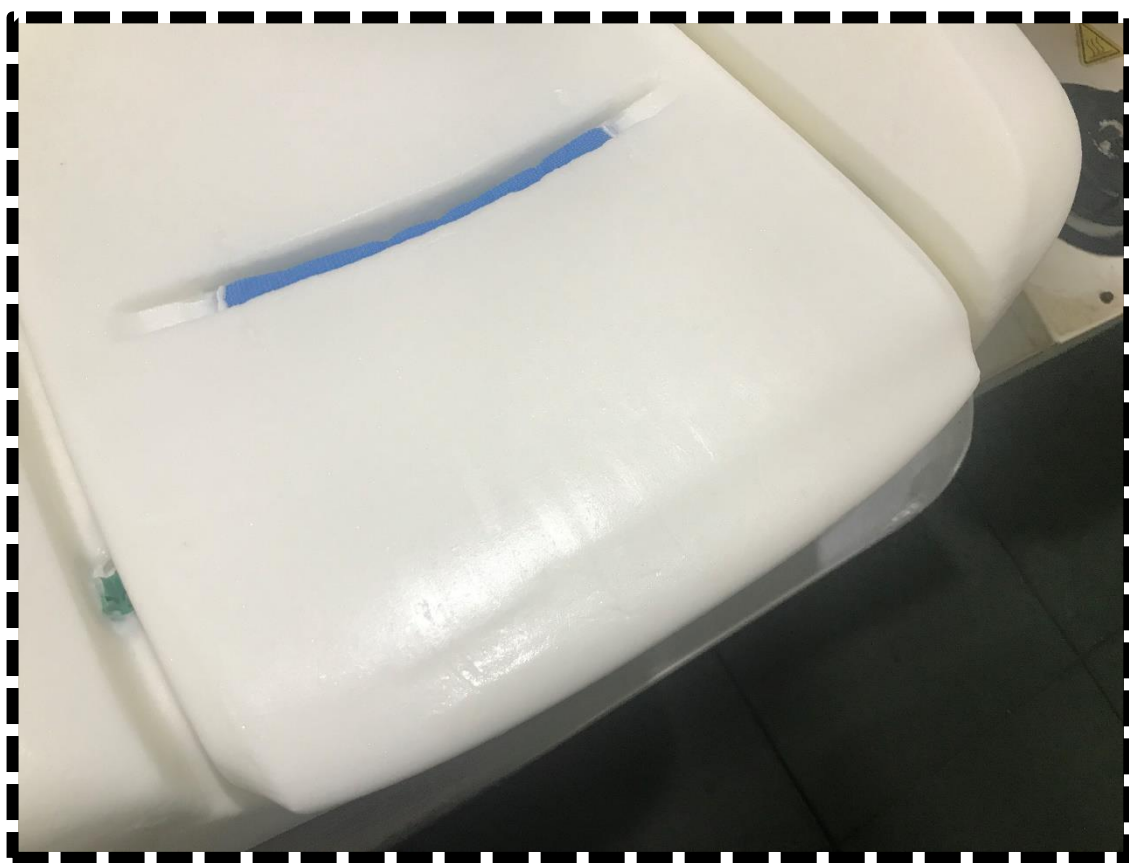
Figura 55 - Zona do Assento Lateral com marca da zona do ISOFIX que veio apoiada nesta espuma
