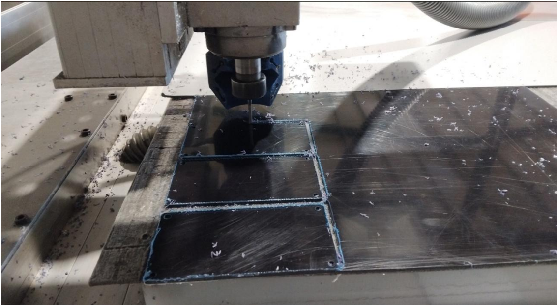
Figura A-2: Roteadora CNC a maquinar placas em policarbonato preto.
