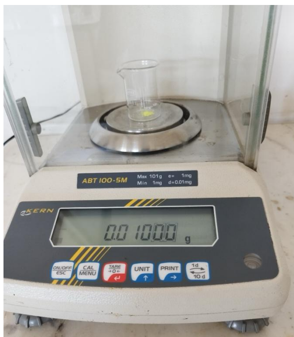
Figura 29 - Massa de BaP aferida por uma balança de precisão utilizada para a confeção dos padrões.
