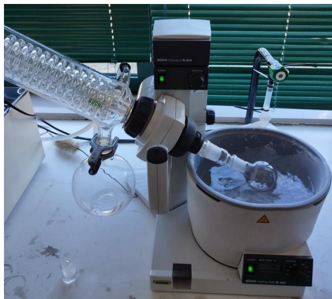
Figura 32 - Método de concentração da amostra por evaporação rotativa.
