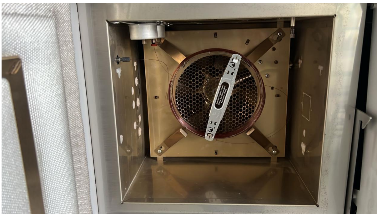
Figura 26 – Forno do Cromatógrafo com a coluna capilar de sílica fundida.
