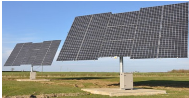
Figura 2.12: Seguidor de dois Eixos (fonte: [29]).
