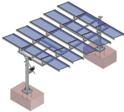
Figura 2.10: Seguidor de Eixo Horizontal (fonte: [27]).
