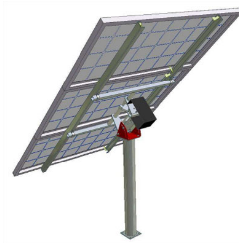
Figura 2.11: Seguidor de Eixo Vertical (fonte: [28]).
