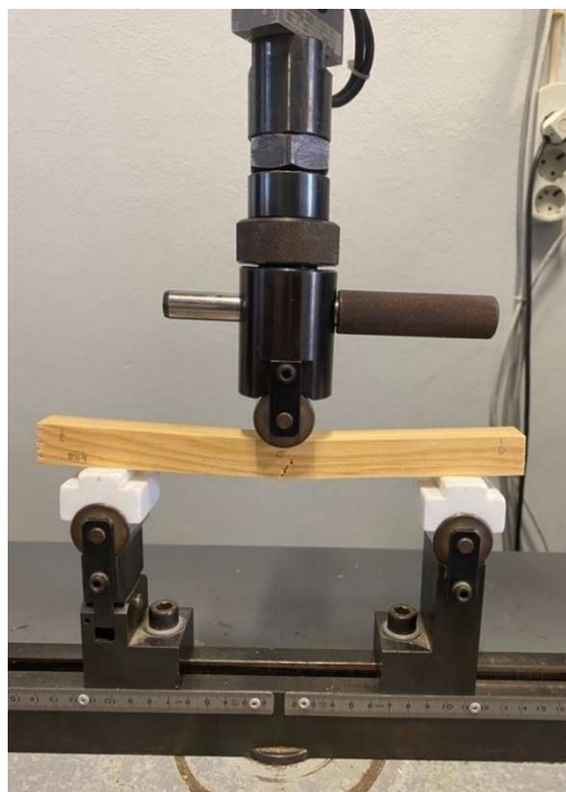
Figura 6: Rotura por Flexão.
