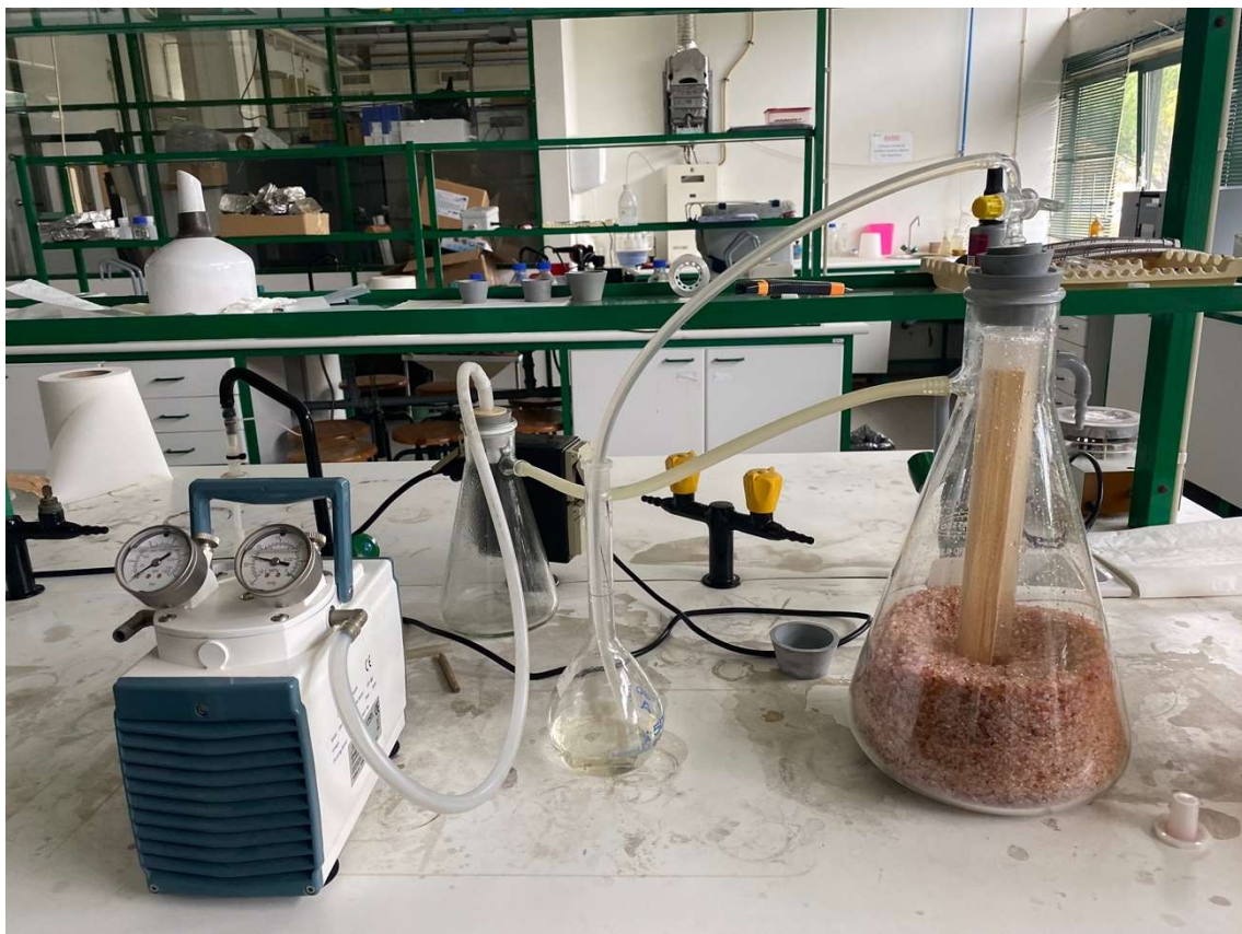
Figura 3: O processo de impregnação da madeira.
