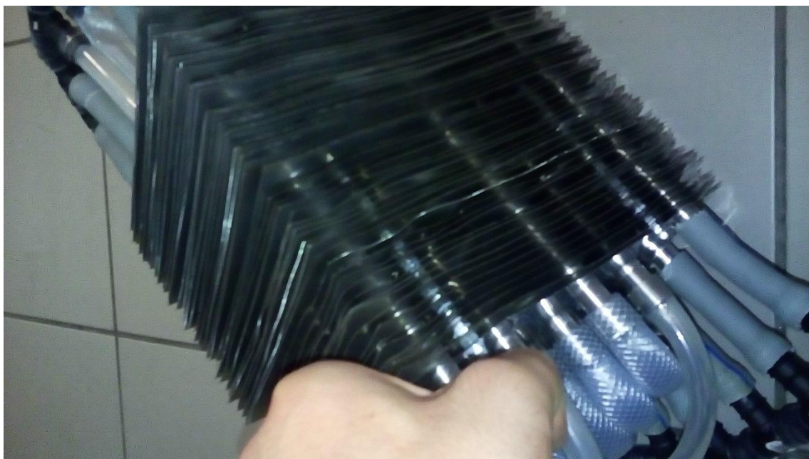
Figura 46: Montagem final do permutador (2).
