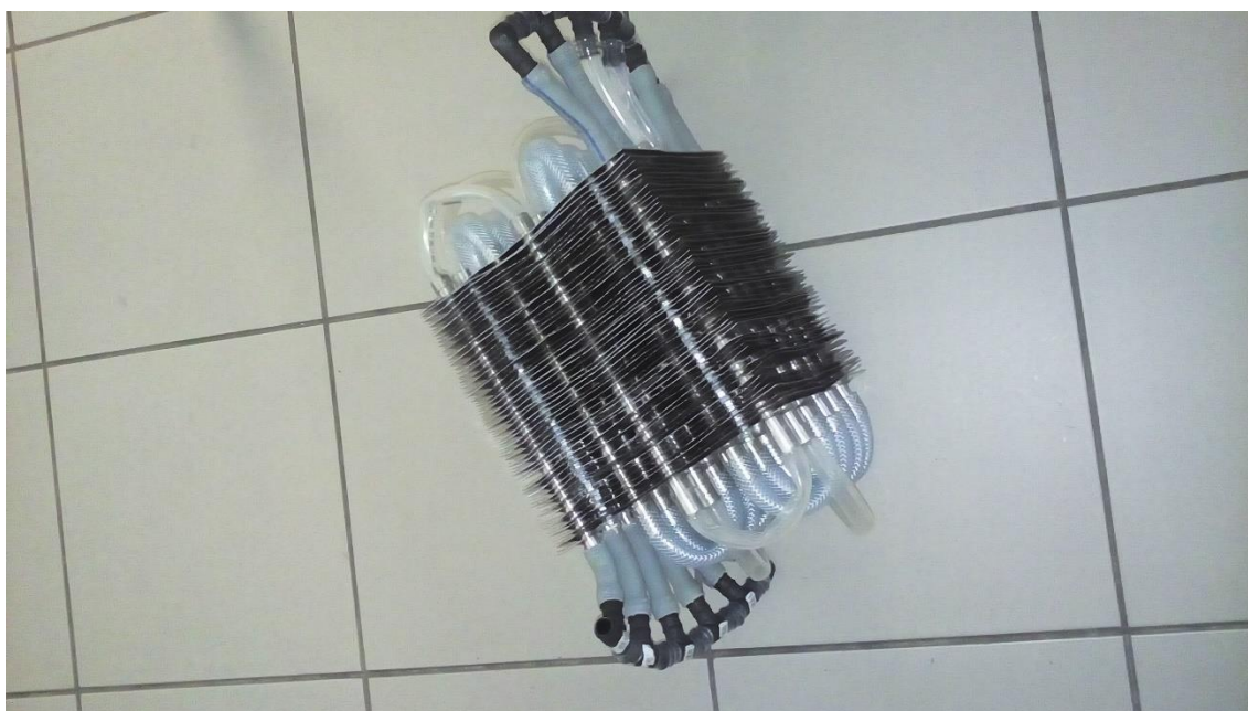
Figura 45: Montagem final do permutador (1).
