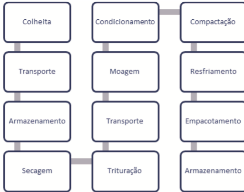
Figura 14: Etapas pelas quais passa a matéria-prima até se obterem os peletes (Dias et al., 2012).
