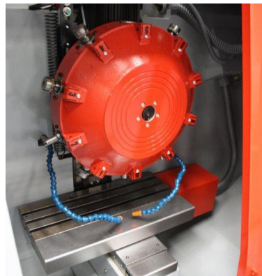
Figura 2-15: Estação de ferramentas armazenada no interior de uma máquina CNC [13].
