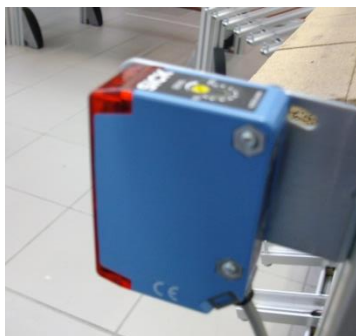
Figura 3-23: Sensor ótico do sistema de segurança e emergência local.
