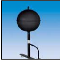
Figura III-3: Sensor de medição da temperatura média radiante
