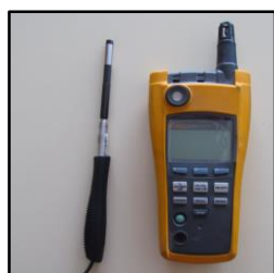
Figura III-7: Instrumento para medição da velocidade do ar
