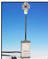
Figura III-5: Sensor de medição da assimetria radiante
