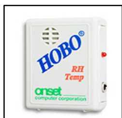
Figura III-8: Data logger utilizado no registo da temperatura exterior
