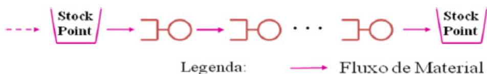
Figura 2-Diagrama representativo de um Sistema Push, adaptado (Guichard, 2009, p.5).
