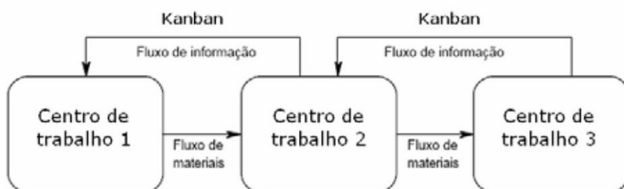
Figura 8 – Modo de funcionamento do sistema kanban , adaptado (Pinto, 2008, p.18).
