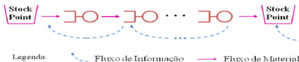
Figura 3- Diagrama representativo de um Sistema Pull, adaptado (Guichard, 2009, p.6).
