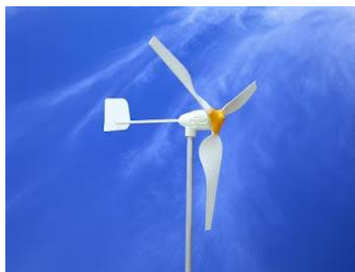
Figura 2-14 Aero gerador de sustentação ou eixo horizontal
