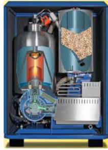
Figura 2-20 Unidade de microgeração “Sunmachine Pelle”
