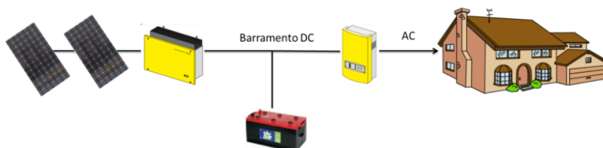
Figura 3-3 Esquema para sistema autónomo dotado de gerador PV
