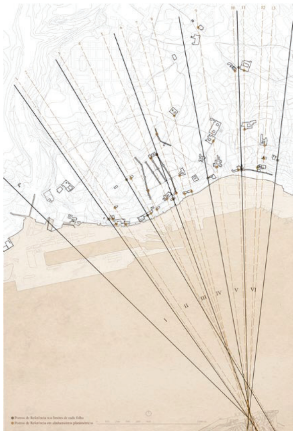
FIGURA 5 Área abrangida pela vista dividida nas respectivas secções/folhas (I-VI), alinhamentos planimétricos a traçado e todos os elementos legendados na vista representados em planta. Fonte: Laura Martins Guia, 2022.
