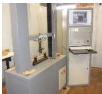
a) Máquina de ensaios universal SERVOSIS ME-405
