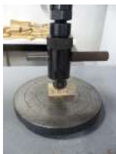
a) Ensaio segundo o método Chalais-Meudon
