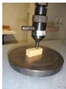
b) Ensaio segundo o método Janka
