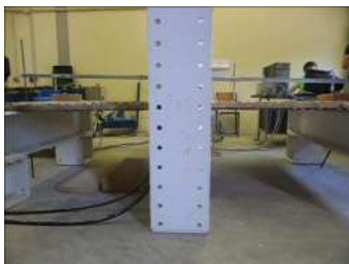
Figura 5-20: Ausência de deformada após o término da aplicação da carga (Parede 1)
