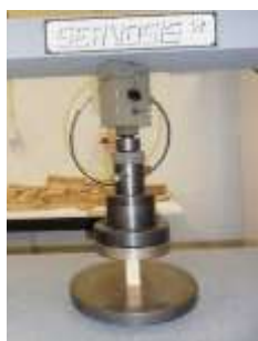
a) Pormenor do ensaio de compressão axial
