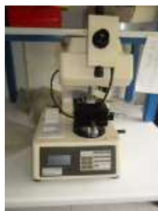
Figura 4-42: Microdurómetro, SHIMADZU HMV-2000
