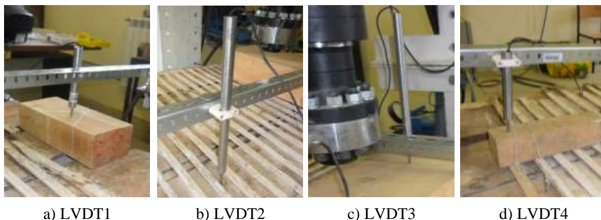
Figura 5-11: LVDTs utilizados (Parede 1)
