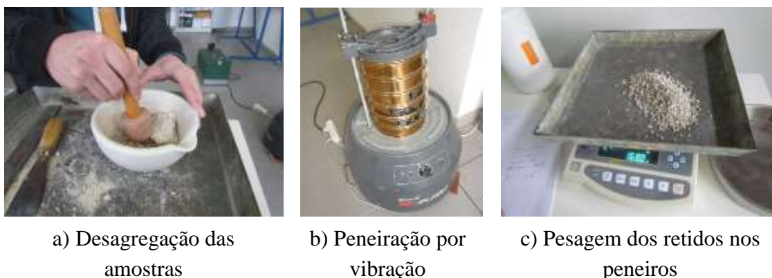
Figura 4-31: Ensaio de peneiração
