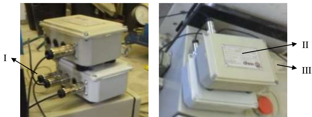
Legenda: I - Entrada dos cabos dos LVDTs; II - Caixa de aquisição; III - Saída para o computador.
