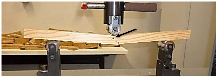
Figura 4-29: Influência dos furos provocados por pregos nas linhas de rotura
