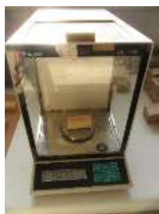
a) Pesagem de cada provete
