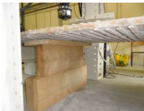
Figura 5-9: Apoio criado a meio vão durante a preparação do ensaio
