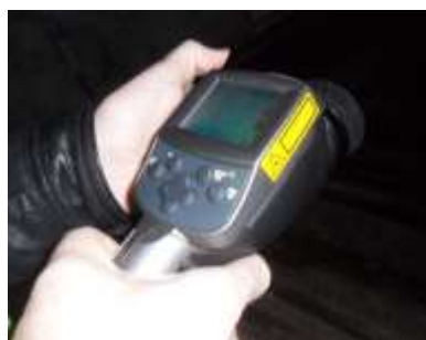
Figura 4-45: Câmara termográfica ThermaCAM E300
