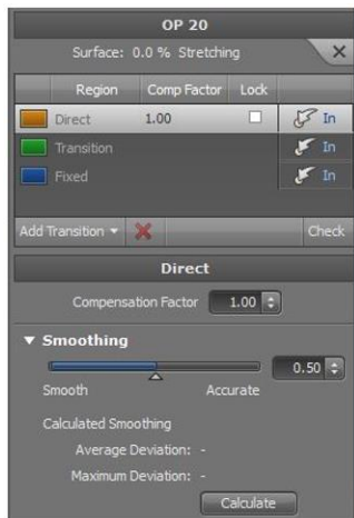
Figura 4.23 - Configuração da compensação da OP20: a) quadro de configuração; b) regiões de compensação (AutoForm Plus R7).
