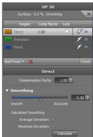
Figura 4.24 - Configuração da compensação da OP30: a) quadro de configuração; b) regiões de compensação (AutoForm Plus R7).
