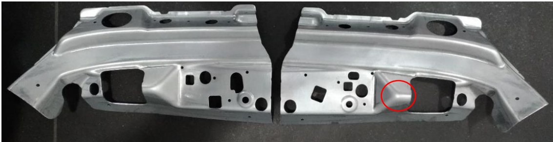
Figura 4.65 - Primeiras peças finais: linha vermelha – zona de visível redução de espessura.
