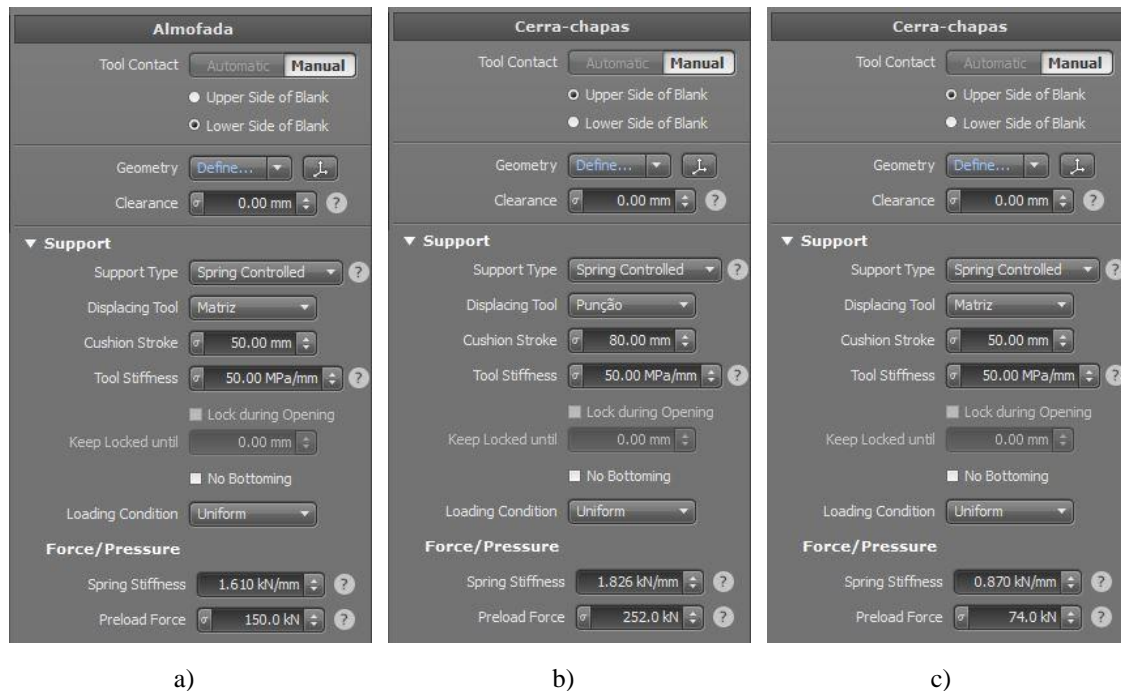
Figura 4.53 - Configuração dos elementos móveis com a aplicação dos cilindros dimensionados: a) OP20; b) OP30; c) OP80 ( AutoForm Plus R7 ).
