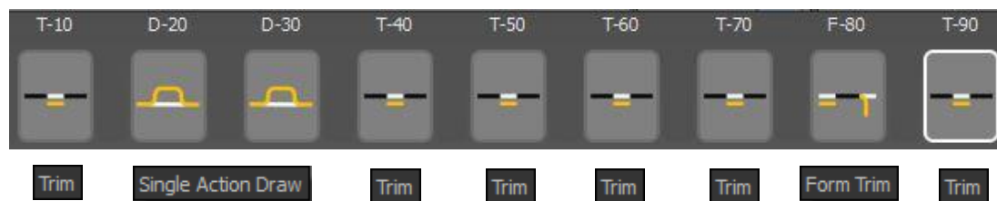
Figura 3.9 - Ciclo de estampagem numérico ( AutoForm Plus R7 ).
