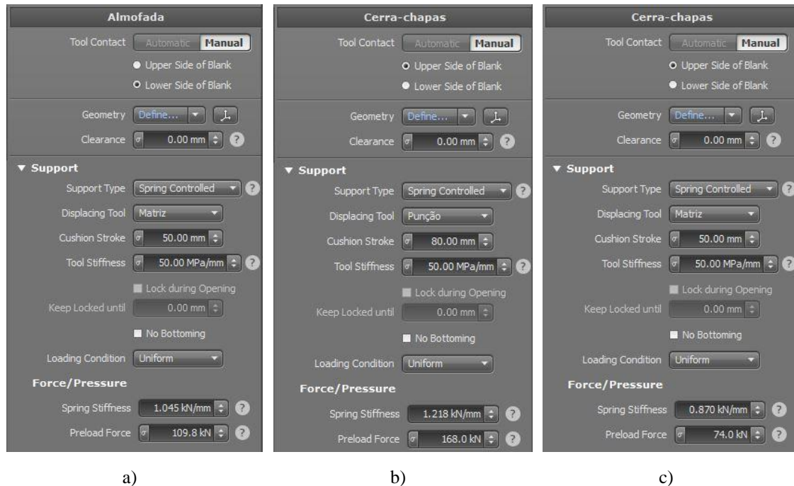
Figura 4.38 - Configuração otimizada dos elementos móveis: a) OP20; b) OP30; c) OP80 (AutoForm Plus R7).
