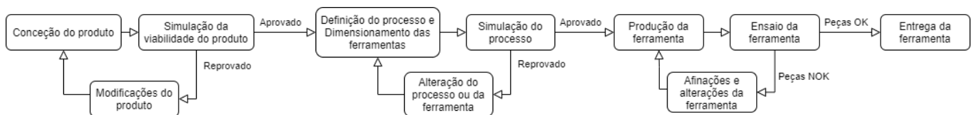
Figura 2.21 - Processo de desenvolvimento de uma ferramenta de estampagem com suporte numa simulação numérica. Adaptado de Tisza & Lukács (2008).
