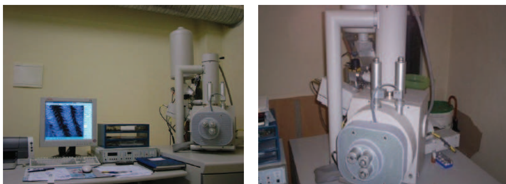
Figura 4-21: Microscópio de Varrimento Eletrónico (Cepeda, 2009)
