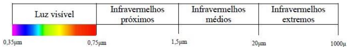
Figura 11: Espectro visível e espectro dos infravermelhos (SOARES, 2014)
