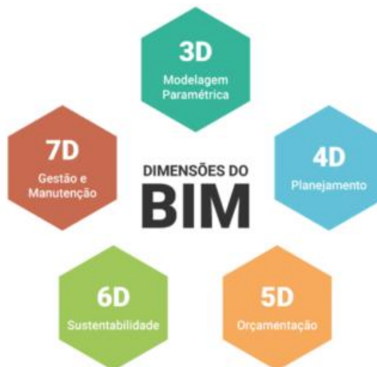
Figura 5: Dimensões da metodologia BIM (GARIBALDI et al, 2020)
