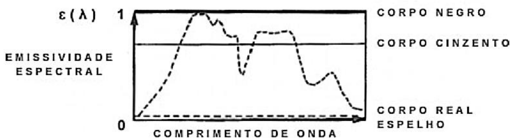
Figura 14: Variação da emissividade de diferentes materiais em função do comprimento de onda (GAUSSORGUES, 1994)
