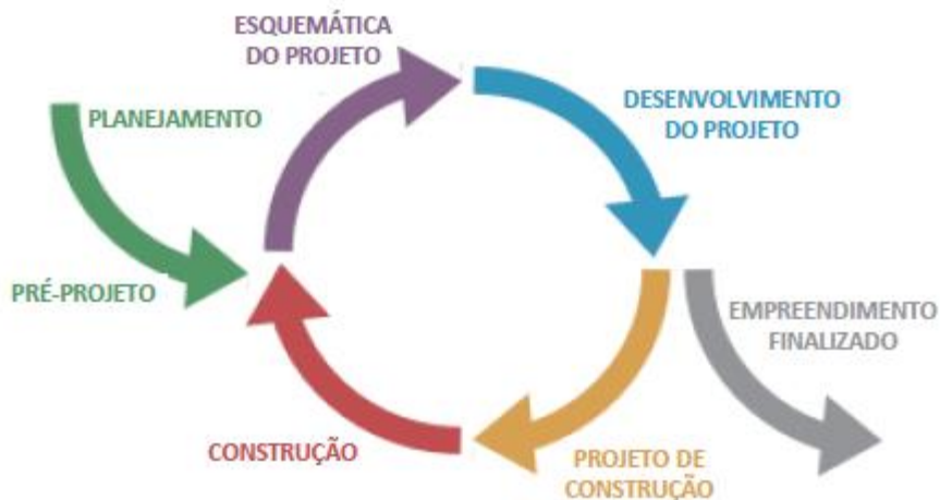
Figura 6: Ciclo BIM relacionado à área da construção civil (adaptado de THOMASSEN, 2011)
