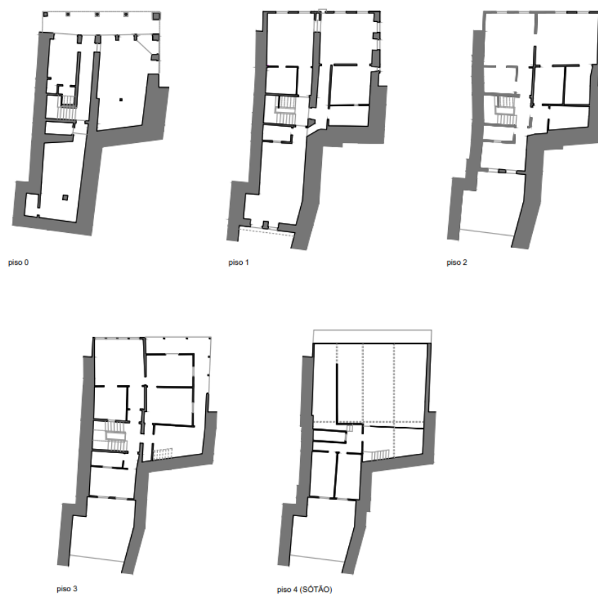
Figura 11 - Plantas baixas dos 5 pisos da Casa dos Balcões.
