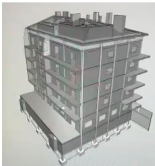
Figura 52 - Modelo de arquitetura e de estruturas do Revit exportado para o Eberick, sem reconhecimento de elementos estruturais.
