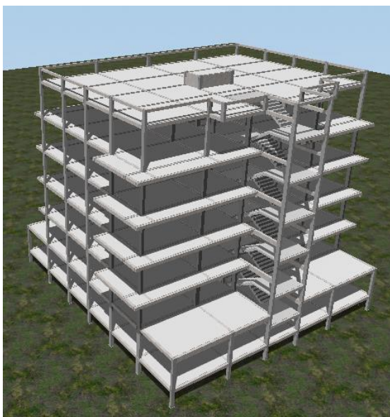
Figura 58 - Modelo 3D da Solução Estrutural 2 no TQS.
