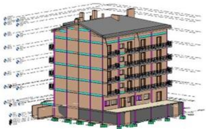
Figura 53 - Sobreposição de elementos estruturais do Eberick com o modelo arquitetônico do Revit.
