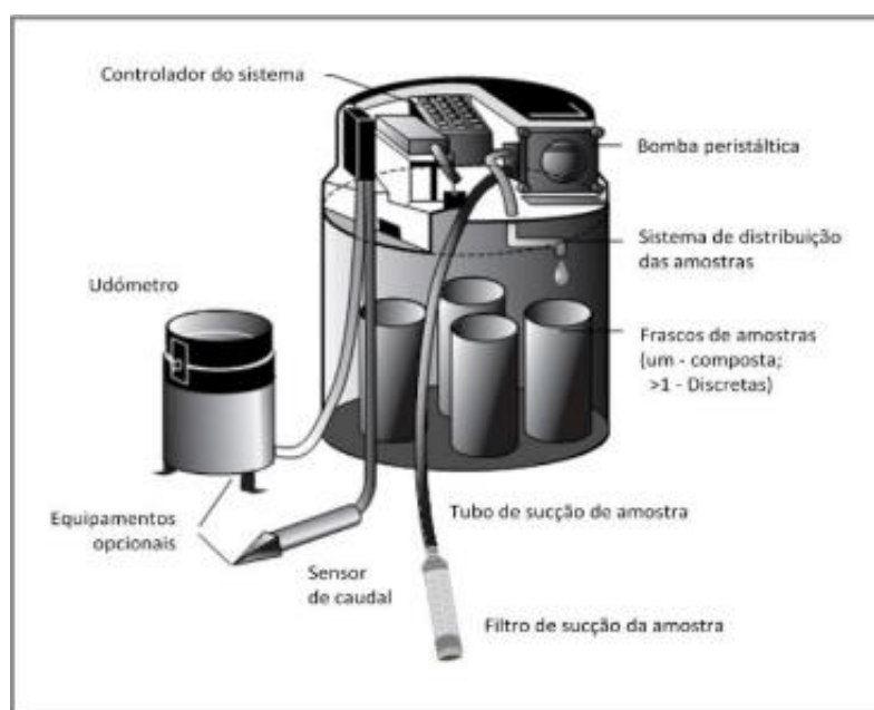
Figura 5-1 – Componentes de um amostrador automático (FHWA, 2003)
