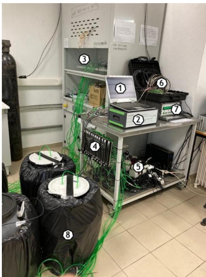
Figura 11- Vista do ensaio de compostagem à escala piloto e do equipamento usado para medir as emissões gasosas.
