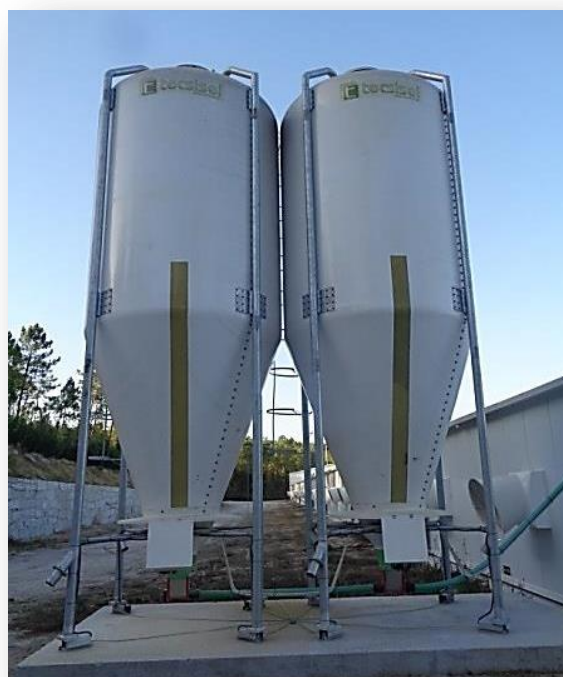
Figura 31: Silos para armazenamento de ração.
