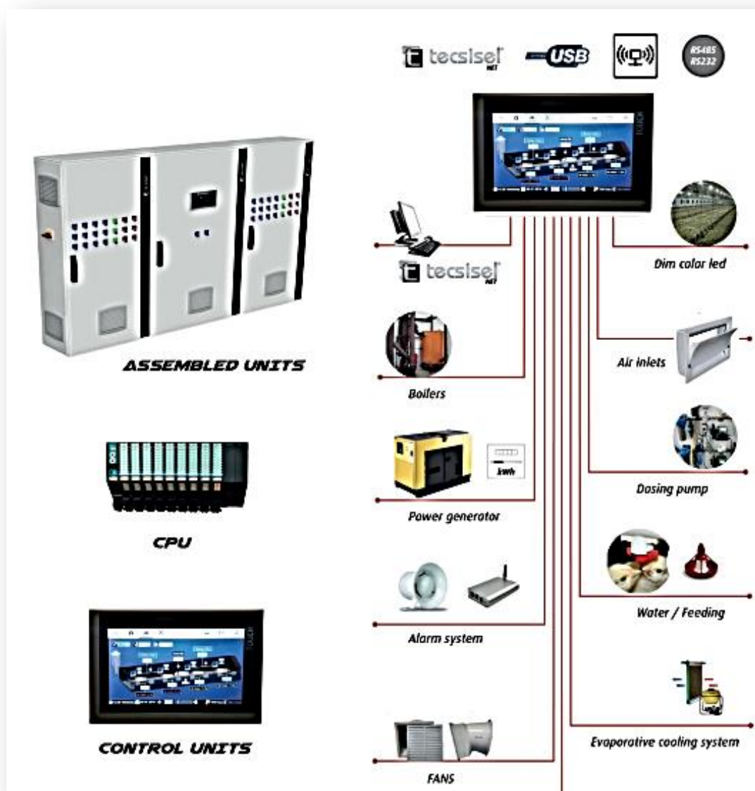
Figura 28: Representação esquemática do sistema de controlo – aviário.
