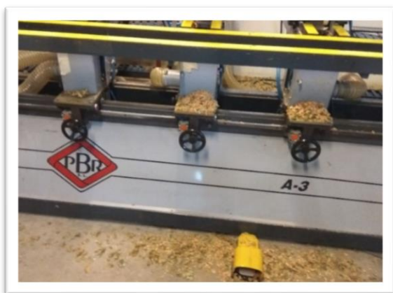
Figura 17 - Furadora PBR com restos de madeira
