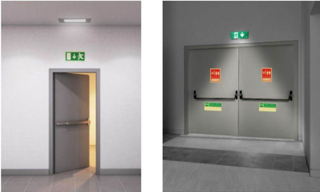
Figura 44 - Localização de luminárias de emergência
