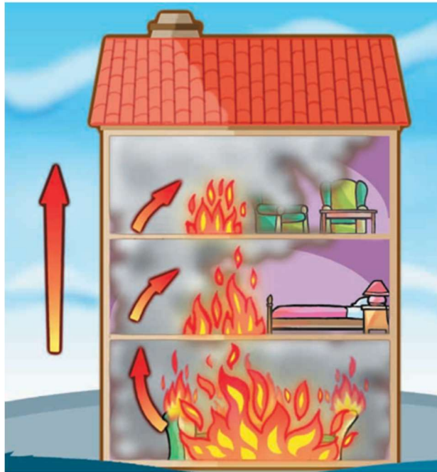
Figura 14 - Transmissão de Calor por Convecção
