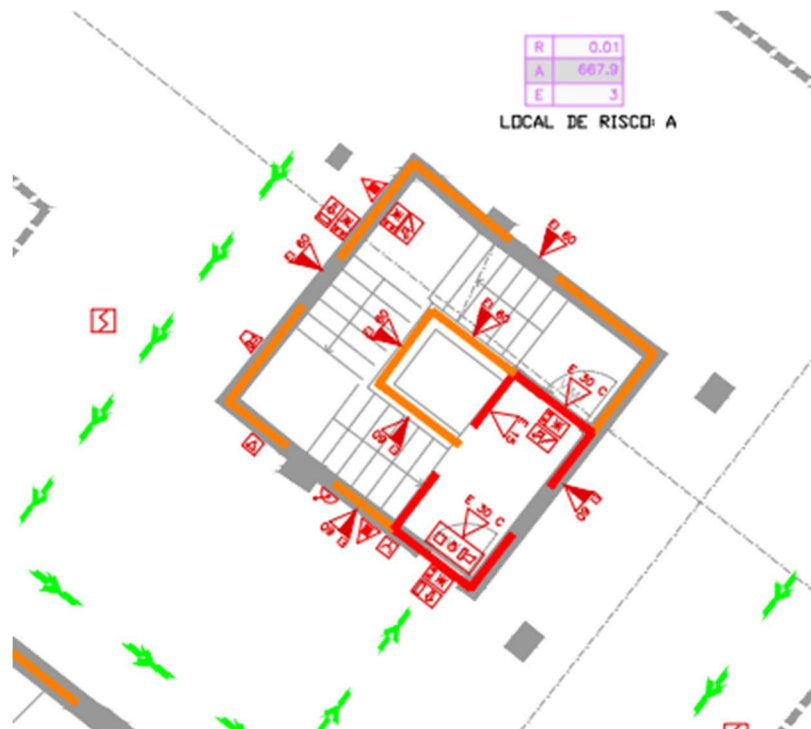
Figura 59 - Compartimentação corta-fogo piso -1
