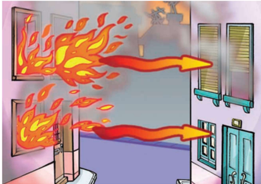
Figura 13 - Propagação de Incêndio por Radiação
