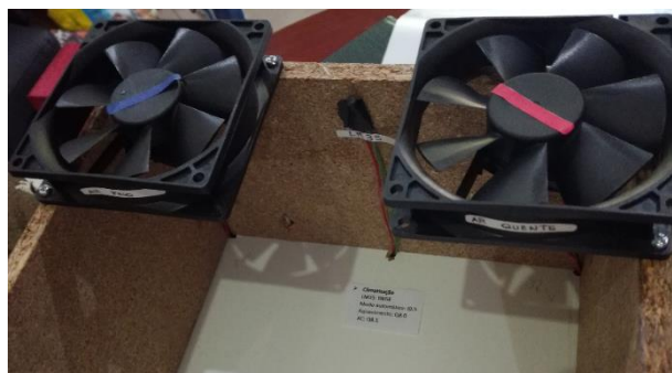
Figura 3-51: Sensor de temperatura e ventoinhas referentes à climatização.
