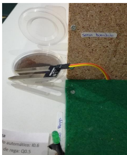
Figura 3-65: Sensor instalado no jardim da maquete.
