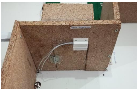
Figura 3-66: Sensor magnético instalado na porta de entrada da maquete.
