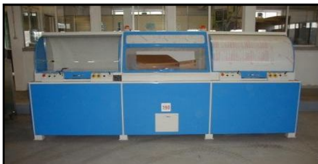
Figura 14 – Tecnologia de tratamento de tubos de raios catódicos.
