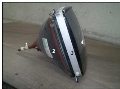
Figura 13 – Tubo de raio catódico. Constituído por: (1) Canhão de electrões; (2) Vidro cónico; (3) Cinta metálica; e (4) Vidro frontal (ecrã).
