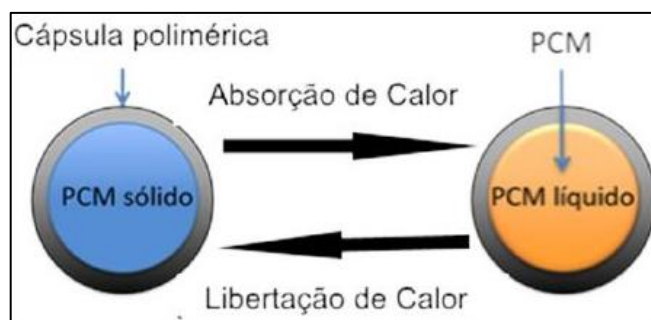
Figura 2-11: Esquema representativo do comportamento térmico do PCM microencapsulado, adaptado de [36]
