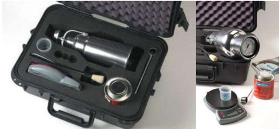
Figura 20 - Equipamento para o Método do Carbonato de Cálcio
