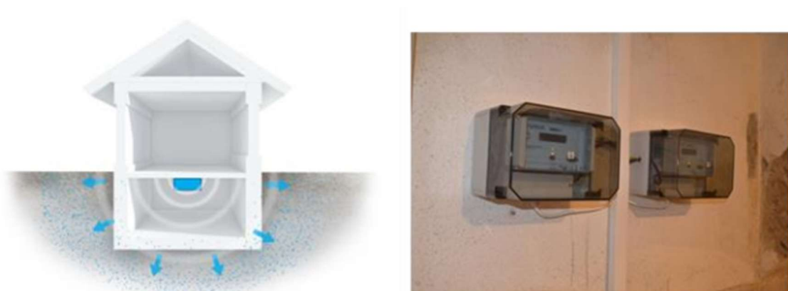
Figura 53 - Princípio de funcionamento do impulso eletrônico e dispositivo instalado
