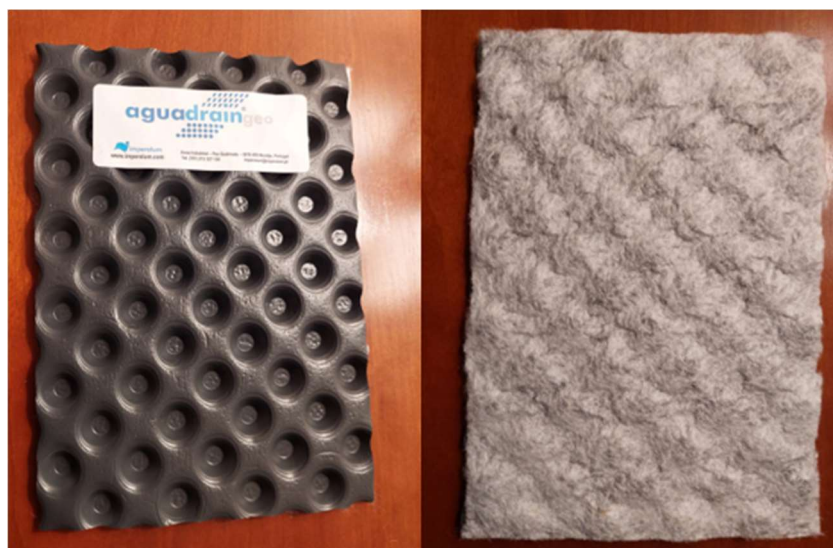
Figura 29 - Lâmina granular em polietileno de alta densidade com geotêxtil incorporado
