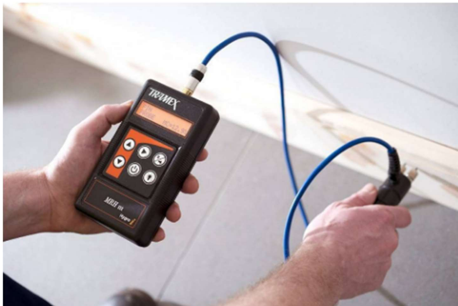
Figura 16 - Aparelhos baseados na Resistência Elétrica
