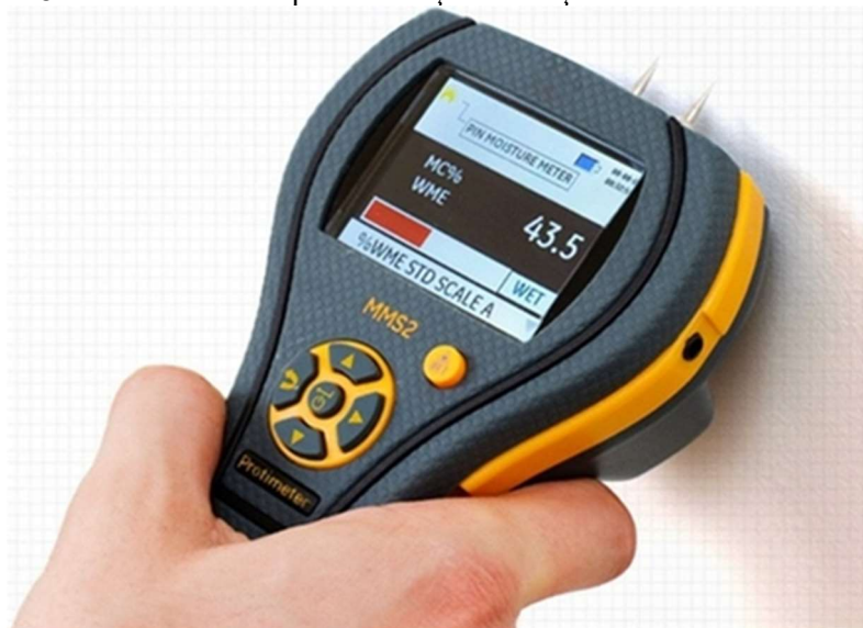
Figura 18 - Sistema MMS2 para avaliações avançadas de humidade de edifícios
