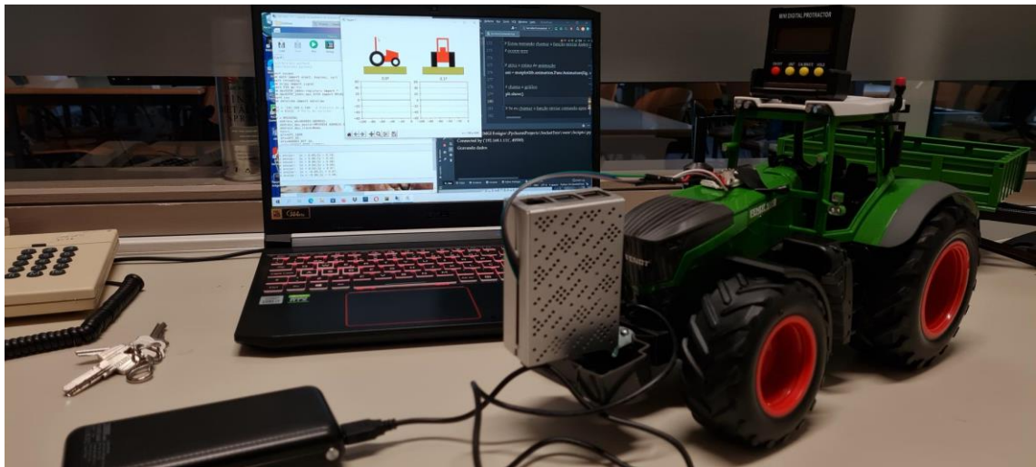
Figura 9 - Instalação do sistema de aquisição de dados
