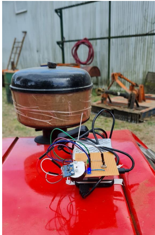
Figura 23 - Sistema de aquisição de dados instalado no trator
