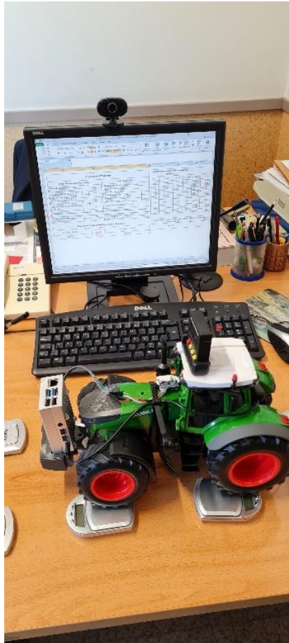
Figura 3 - Medição do centro de massa e ângulos críticos
