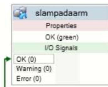
Figura 5-29: SmartComponent de uma lâmpada de sinalização.
