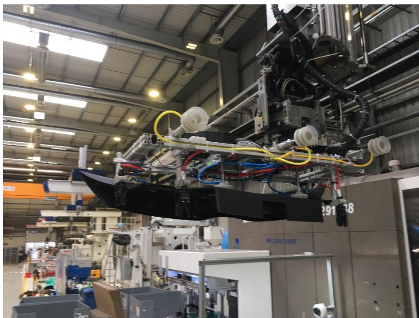
Figura 4-19: Mão robótica a segurar no molde plástico.
