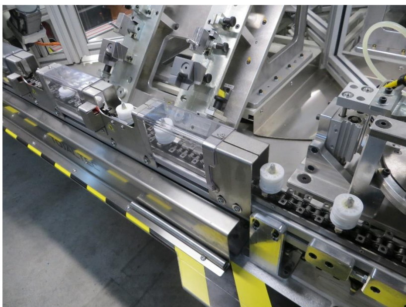
Figura 5-8: Sistema de distribuição de polias.
