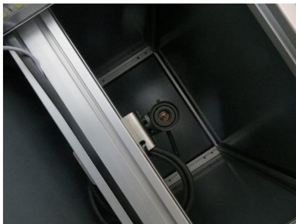
Figura 5-17: Câmara CA-035M dentro de caixa escura.
