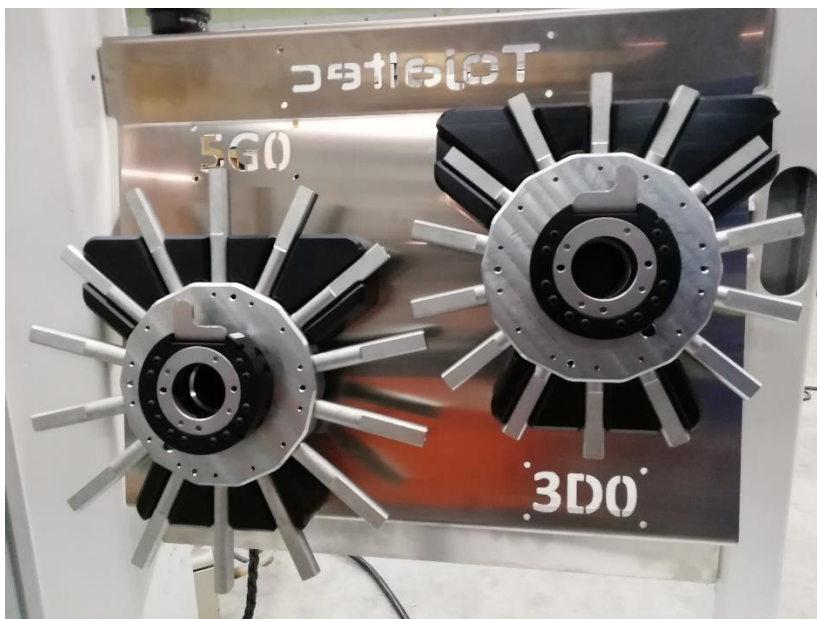
Figura 3-6: Armazém de ferramentas.
