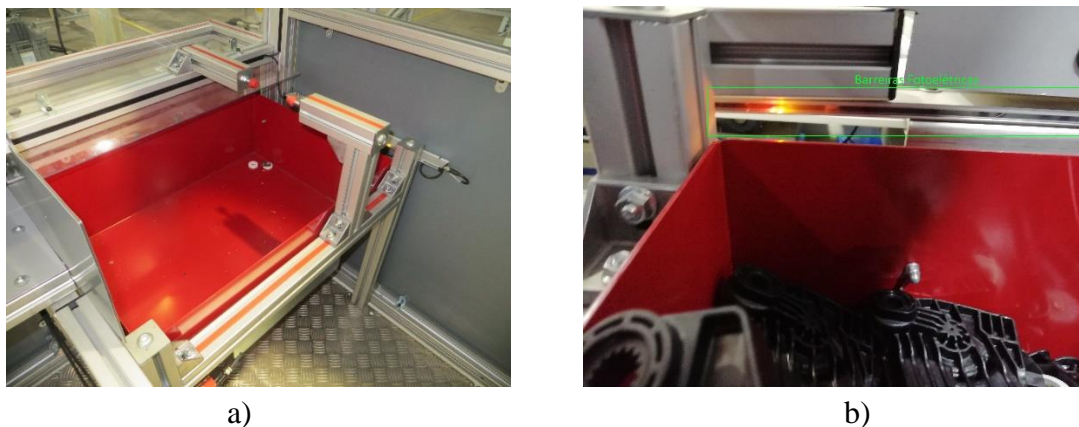
Figura 5-20: Gaveta de rejeição: a) gaveta; b) sensor de barreira.
