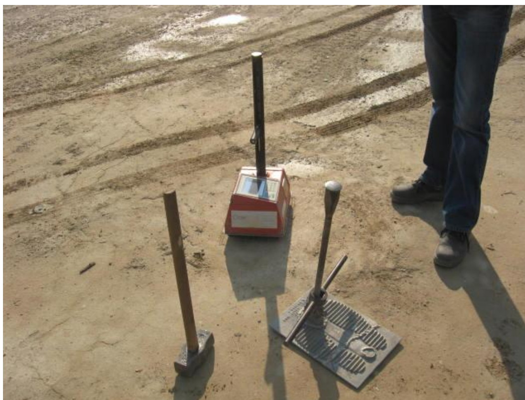
Fig. 16 – Ensaio da 2ª camada (rectificada) do solo do aterro: Gamadensímetro.
