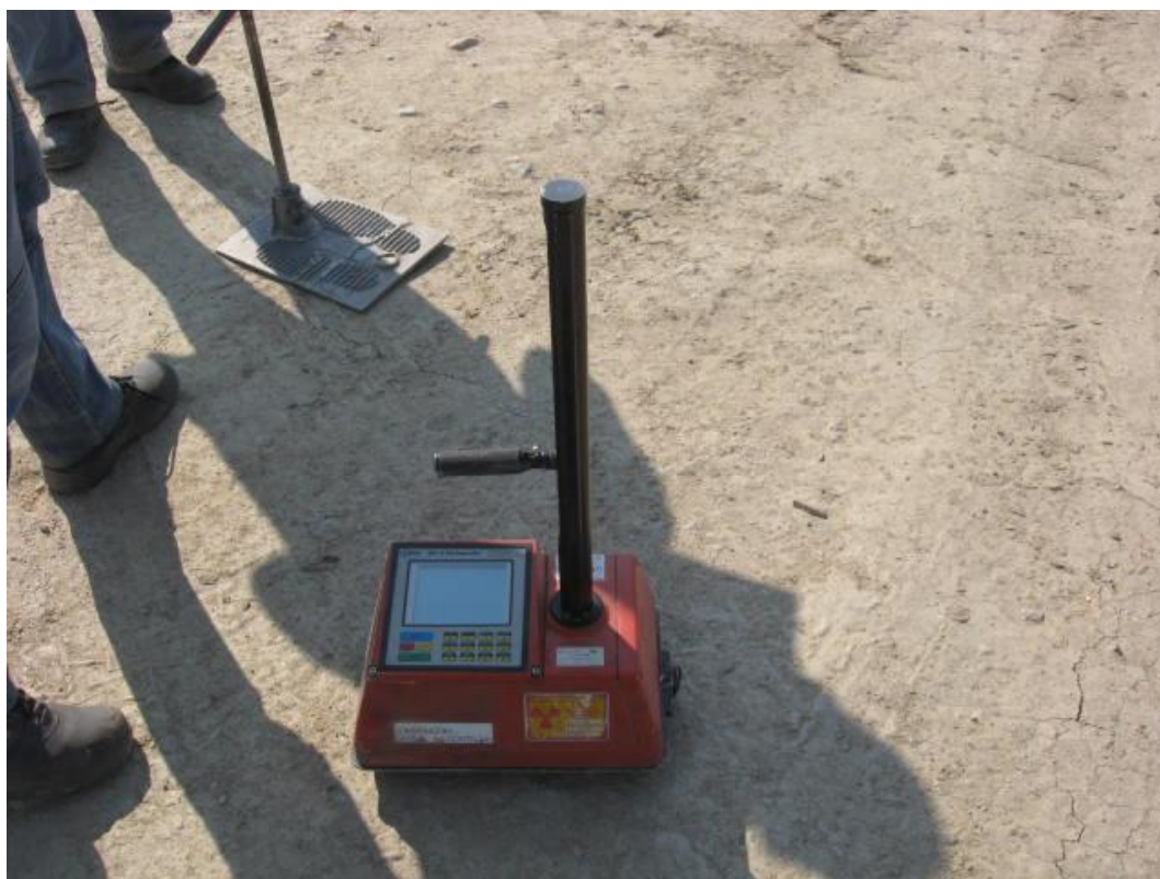
Fig. 4 – Ensaio da 1ª camada do solo do aterro: Gamadensímetro.
