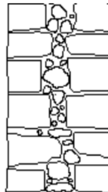
Figura 17 - Parede de alvenaria de pedra de dois paramentos sem ligação (edifício situado em Mangualde)
