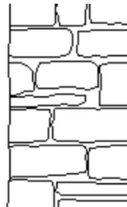
Figura 16 - Paredes de alvenaria de pedra de paramento simples de grande espessura (edifício situado em Lamego)
