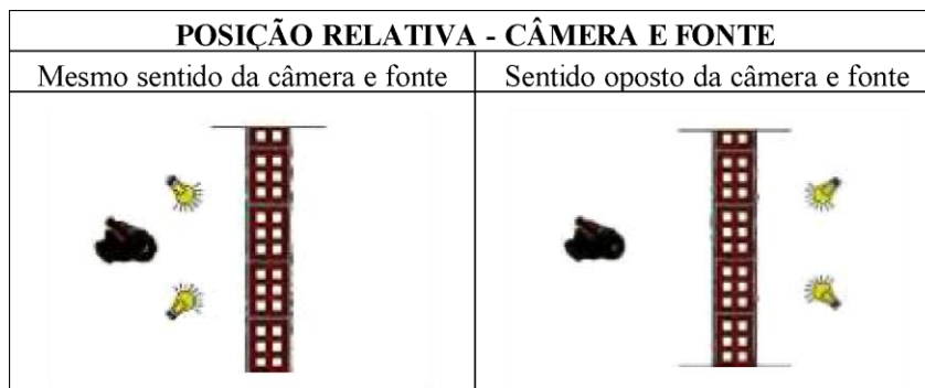
Figura 6: Técnica de termografia ativa (CORTIZO, 2007)
