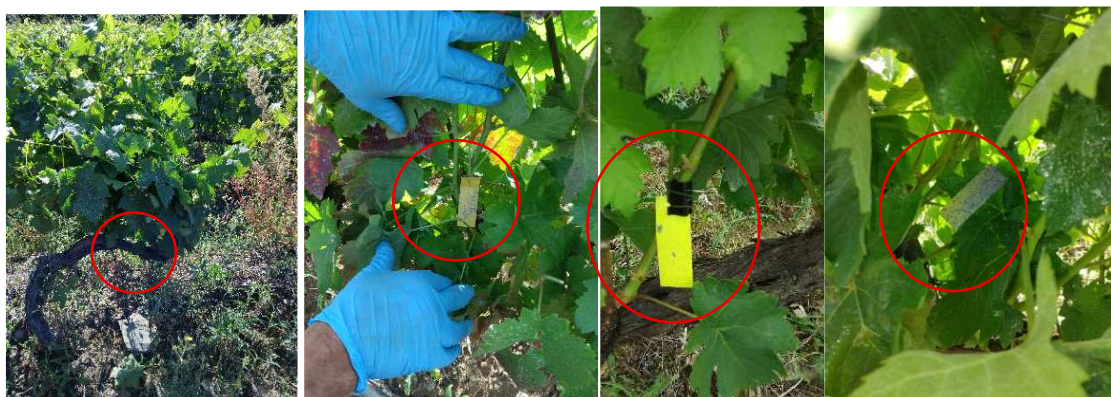
Figura 19. Colocação dos papéis hidrossensíveis na copa das videiras para observação da qualidade da pulverização
