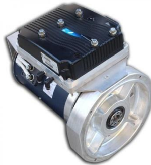
Figura 6-5: Montagem do conjunto motor e controlador Curtis [57].
