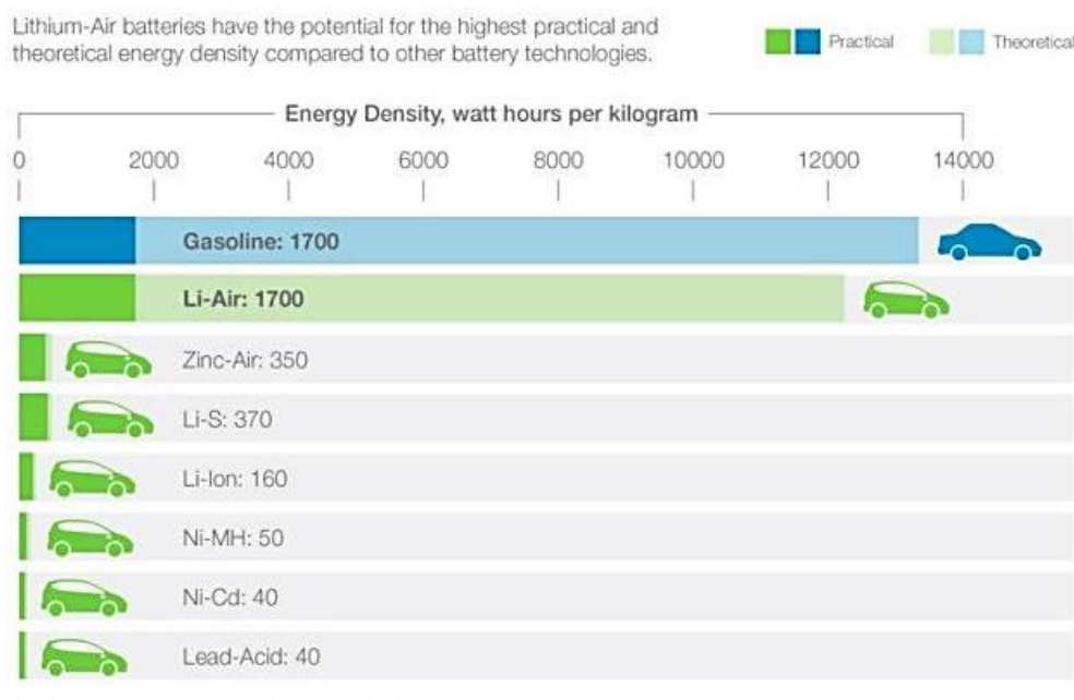
Figura 4-7: Densidade de energia para diferentes tecnologias de armazenamento [40].
