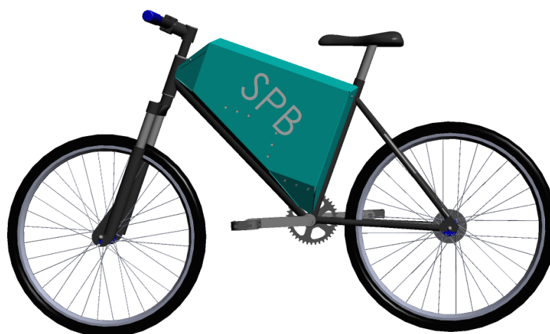
Figura 5-10: Aspeto final do quadro com a caixa para as baterias.
