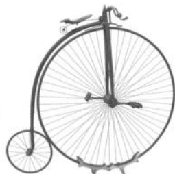
Figura 2-5: A Grand Bi com raios de arame rígido. Fonte: [11].
