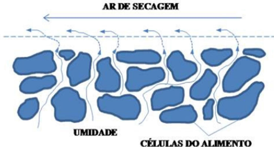
Figura 9 - Representação esquemática do movimento de água durante a secagem (Fonte: Fellows, 2000)
