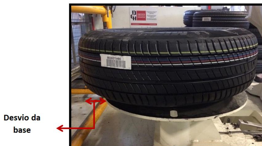
Figura 48: Roda fora dos limites na base intermédia
