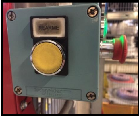
Figura 8: Botão de rearme da barreira de entrada e saída
