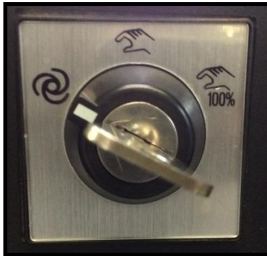
Figura 12: Chaves que define o modo de controlo: acionado o modo automático
