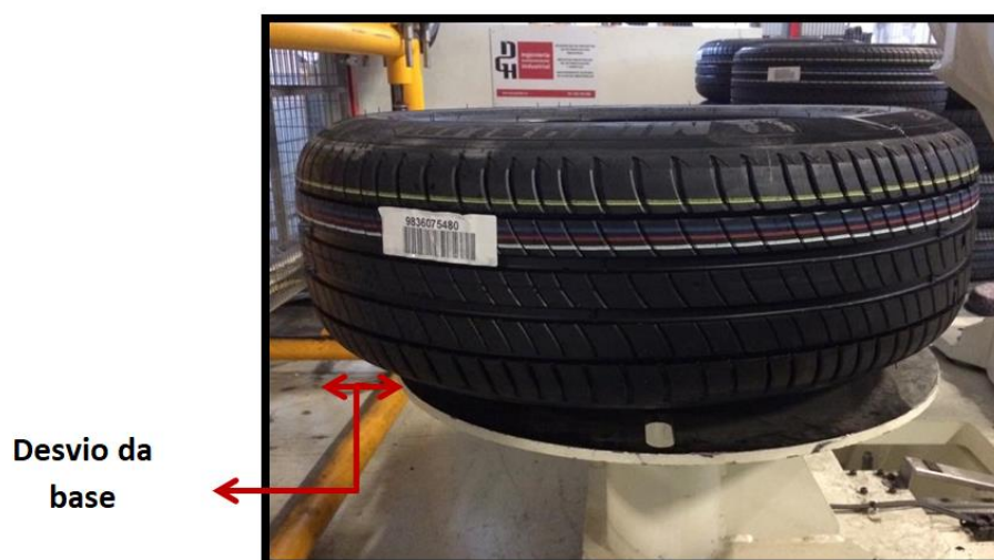
Figura 24 - Roda descentrada na base rolante.
