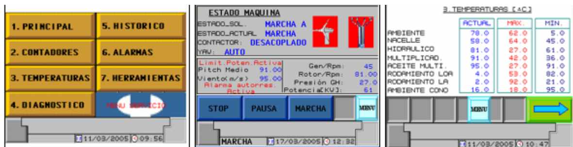
Figura 38- Display de controlo do aerogerador
