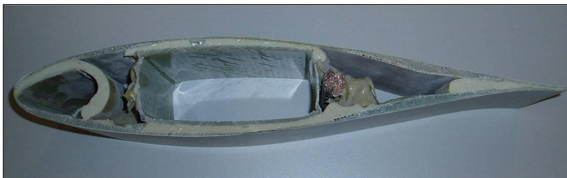
Figura 25 - Vista da pá em corte transversal
