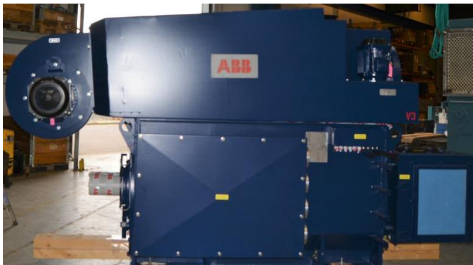
Figura 34- Imagem real de um gerador ABB Amk500 (ABB Generator AMK500 L4A BATYH Gamesa, 2020)
