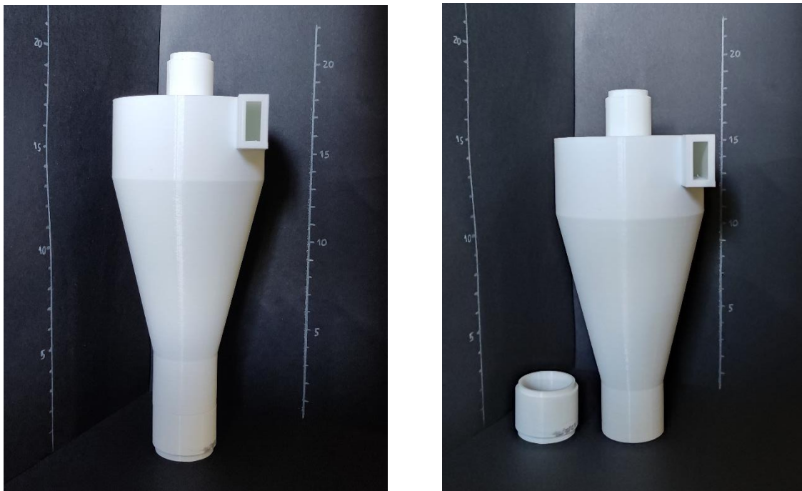
Figura 27 - Impressão da modelação com implementação dos testes de tolerância
