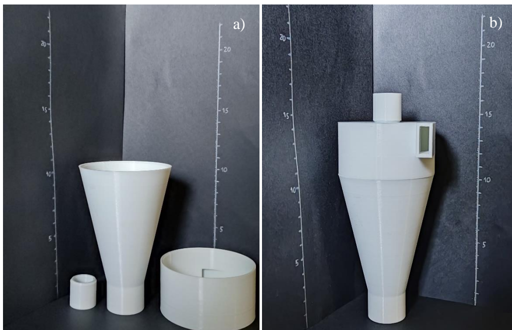
Figura 23 - Segunda iteração de impressão 3D. Painel a) peças isoladas; Painel b) Ciclone montado
