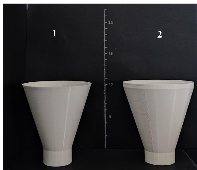
Figura 24 - Modificação do encaixe das peças
