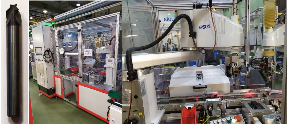
Figura 76 - Exemplo de uma fresa (esquerda) e equipamento de fresagem (centro e direita) utilizado nos processos de fresagem das linhas de produção de acessos mecânicos.
