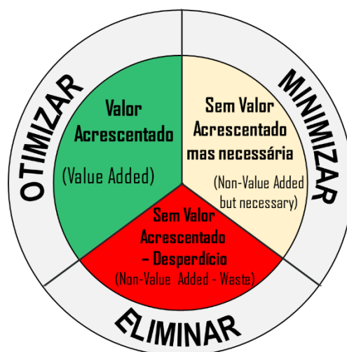
Figura 17 - Classificação das atividades na indústria. Fonte: Fonte própria e adaptado de Huf Portuguesa (sem data)
