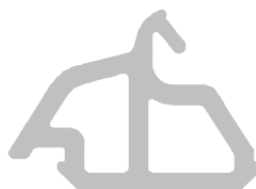
Figura 44 - Proposta de novo vedante central com caixas de ar (fonte: PERVEDANT).
