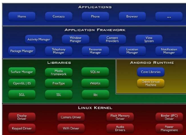
Figura 25 - Componentes do sistema Android ( http://buildall.wordpress.com/2009/11/15/arquitetura-do-google-android/ )
